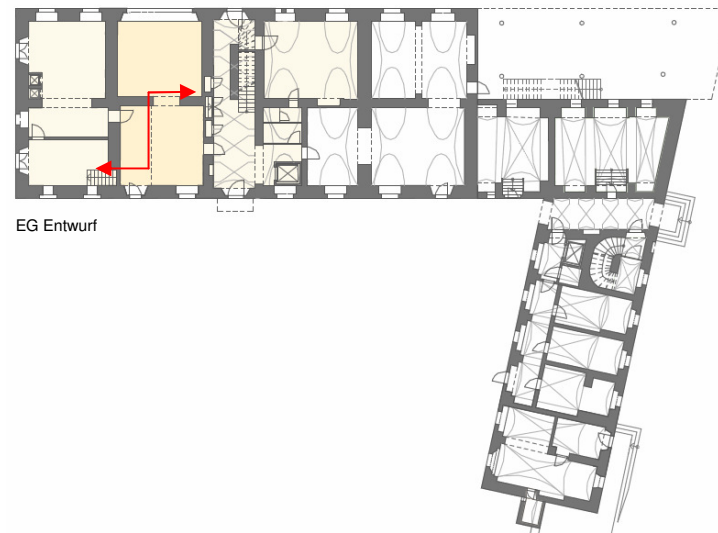
Abb.34: Hier ist der unterkellerte Bereich rot gekennzeichnet..
