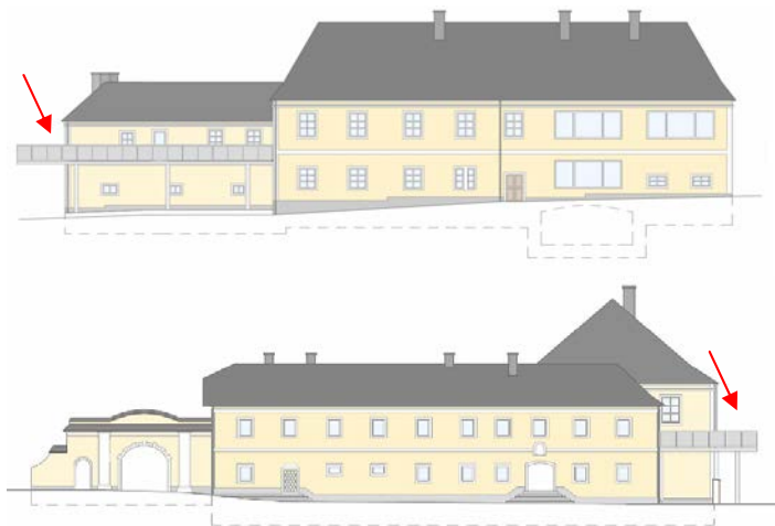
Abb.54: Die neue Aussichtsplattform grenzt an die Bibliothek an und bietet eine schöne Erweiterung. (Entwurfspläne – oben: Nordwestansicht, unten: Nordostansicht)
