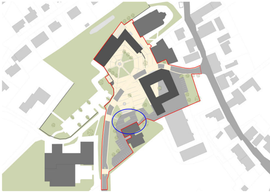
Abb.62: Am Gemeindevorplatz werden Kopfsteinpflasterstreifen in den Asphalt gelegt um das Netz optisch noch fortzusetzen.
