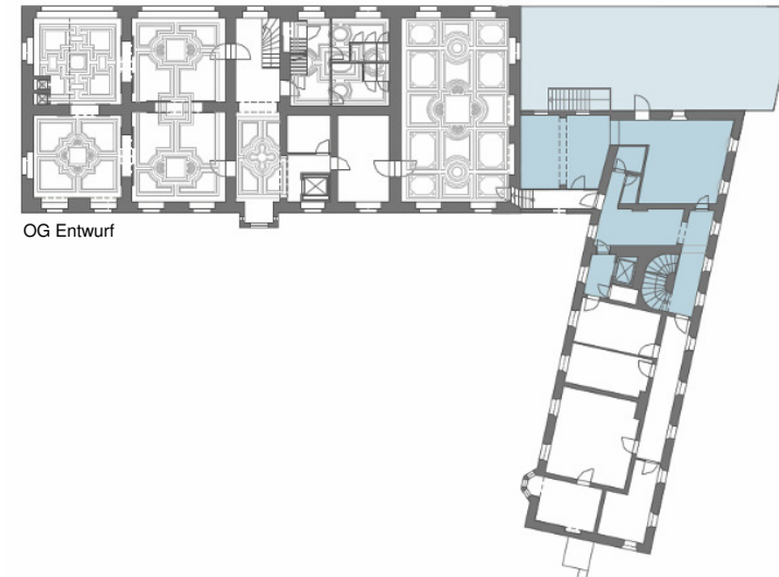
Abb.52: Die neue Aussichtsplattform hat eine Fläche von 120m 2 und bietet eine großzügige Bibliothekserweiterung. (Sie wird hellblau dargestellt.) Bei Schönwetter kann man hier Bücher lesen oder auf jemanden warten.
