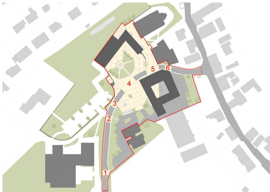
Abb.32: Sechs "Pflasterterpiche" unterbrechen die ehemals durchgängig asphaltierte Straße.
