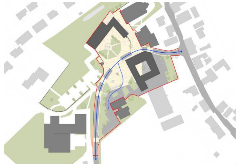
Abb.28: Im Entwurf bleibt die Wegführung bestehen. Durch die Pflasterung entsteht allerdings gewollte Verwirrung, da die Straße mehr wie ein Platz als eine Durchzugsstraße wirkt.
