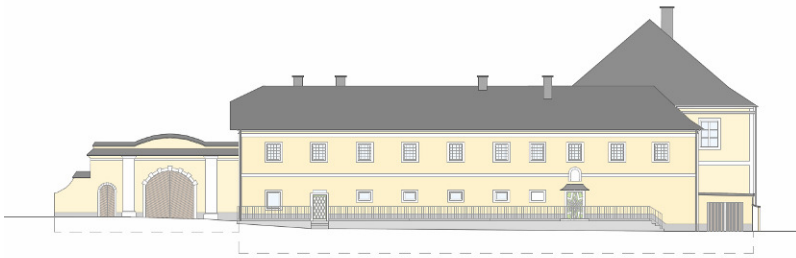
Abb.79: Nordostansicht. Links an das Gebäude angefügt befindet sich eine Mauer mit Toren. Rechts an das Gebäude angefügt befindet sich eine Garage, diese wird im Entwurf abgerissen. (Zugänge von links nach rechts: 1. Besprechungsraum, 2. geschlossener Durchgang zum neuen Ortsplatz).
