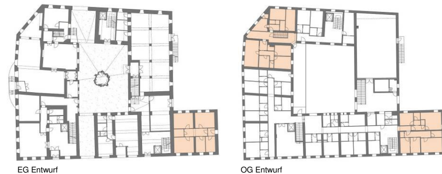
Abb. 16: Entwurf. Im Erdgeschoss (links) befindet sich eine Wohnung für den Vereinsleiter und seine Familie. Im Obergeschoss (rechts) sind vier Vereinswohnungen angeordnet.
