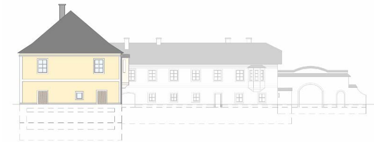
Abb.84: Südwestansicht. Alle Gitter vor den Fenstern werden entfernt. (Zugänge von links nach rechts: 1. Restaurantküche, 2. Lager)
