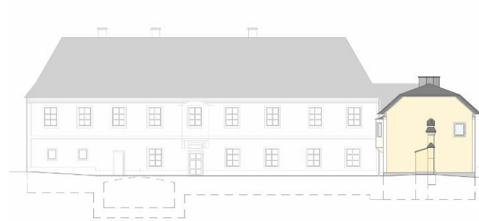
Abb.78: Südostansicht. Diese Fassade bleibt gleich bestehen. Lediglich das Gitter vorm Fenster wird entfernt.
