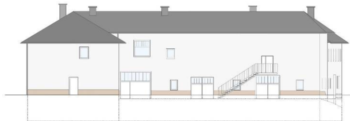
Abb.46: Ansicht Süd. Große Tore an der Fassade verraten, dass sich dahinter eine Einstellhalle verbirgt. Zum Teil stehen diese Räumlichkeiten allerdings leer.
