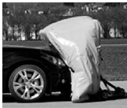
Abbildung 3.11: Verformung der ADAC Fahrzeugattrappe bei Kollision [5]
