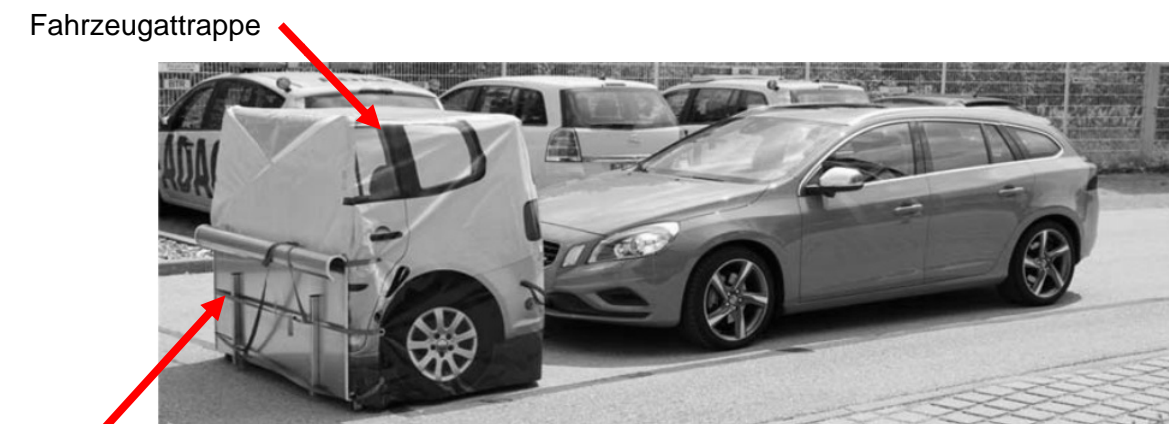
Abbildung 2.32: ADAC Target für stationäre Manöver [6]
