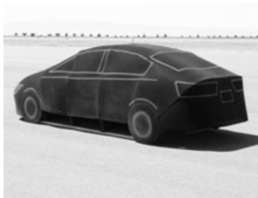
Abbildung 2.43: Auf LPRV montierte Schaumstofffahrzeugattrappe [45]
