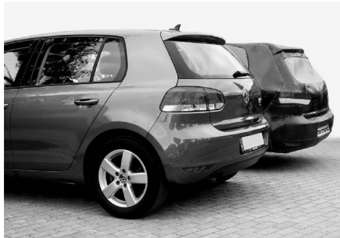
Abbildung 2.38: Vergleich eines realen Fahrzeuges mit dem "b.target" [44]
