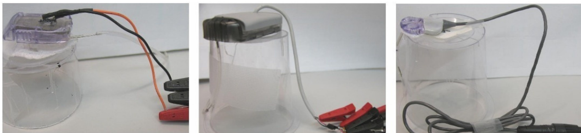
Abb. 16: In vitro Untersuchungen zur Funktion der Sensoren in Insulinflüssigkeiten: In vitro Tests der Sensoren von Dexcom (links), Abbott (mitte) und Medtronic (rechts). Die Sensoren befanden sich in Schläuchen die mit den jeweiligen Insulinflüssigkeiten durchspült wurden.
