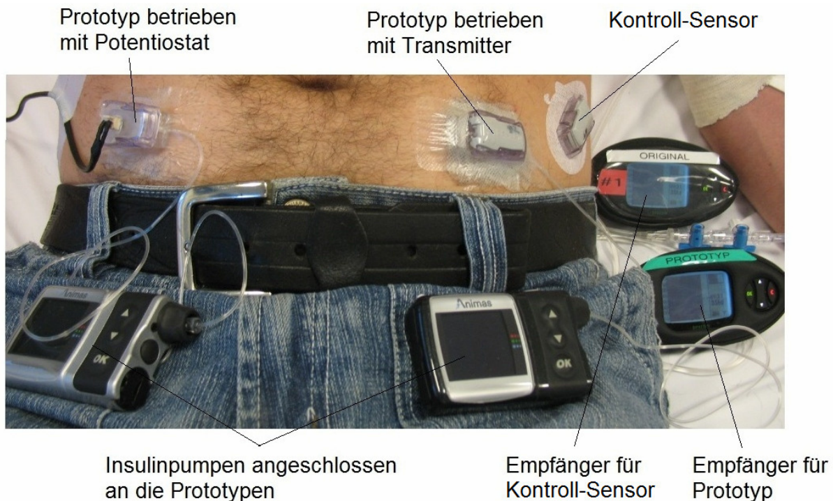
Abb. 28: Anordnung der Prototypen und des Kontroll-Sensors bei gesunden Probanden: Die Prototypen und Kontroll-Sensor wurden ins Fettgewebe des Bauches der Probanden gesetzt. Der Kontroll-Sensor und die Sensoren der Prototypen wurden dann mit einem Potentiostat oder mit einem originalen Transmitter betrieben. Die Infusionskanülen der Prototypen waren über flexible Schläuche an Insulinpumpen angeschlossen mit deren Hilfe Insulin mit unterschiedlichen Raten infundiert wurde.
