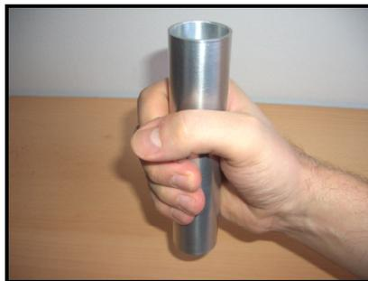
**Abbildung 3-3:** Aktive Elektrode (Aluminiumrohr) wird mit der Hand umfasst
