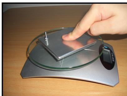
**Abbildung 3-2:** Zeigefinger in Kontakt mit der aktiven Elektrode
