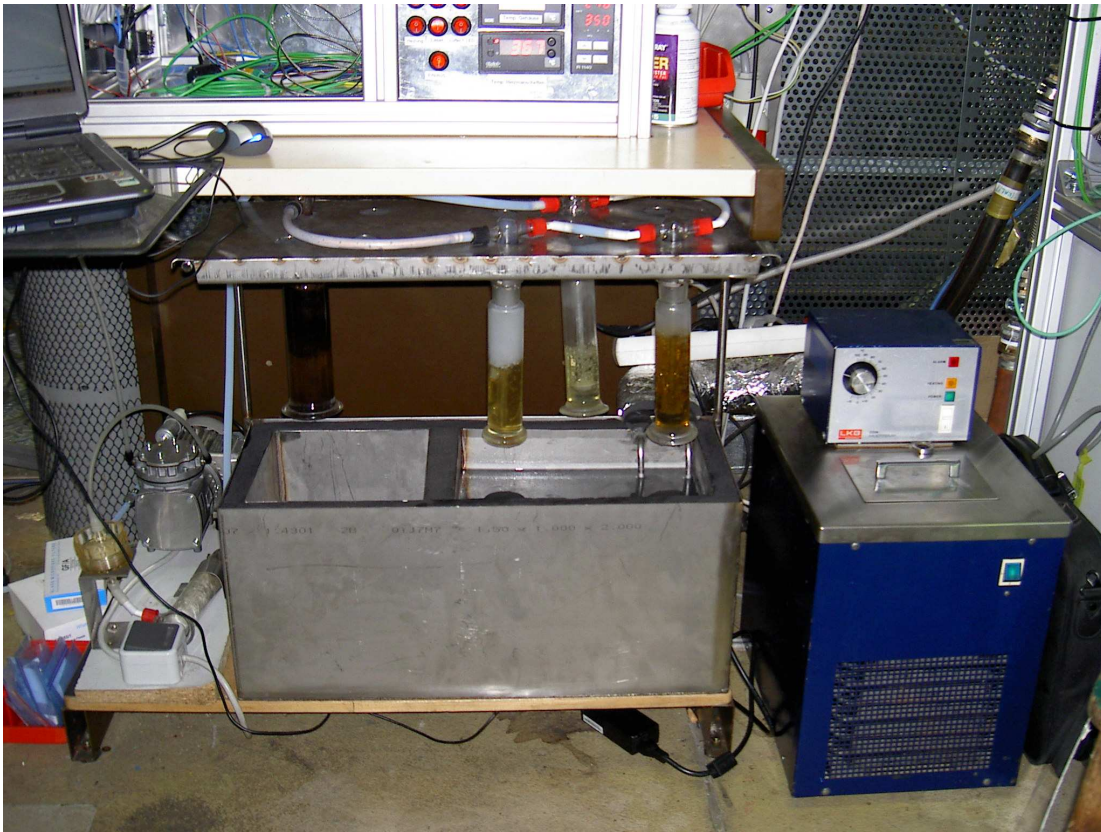
Abbildung 10.2.: Teerwäsche vor der Membranpumpe
