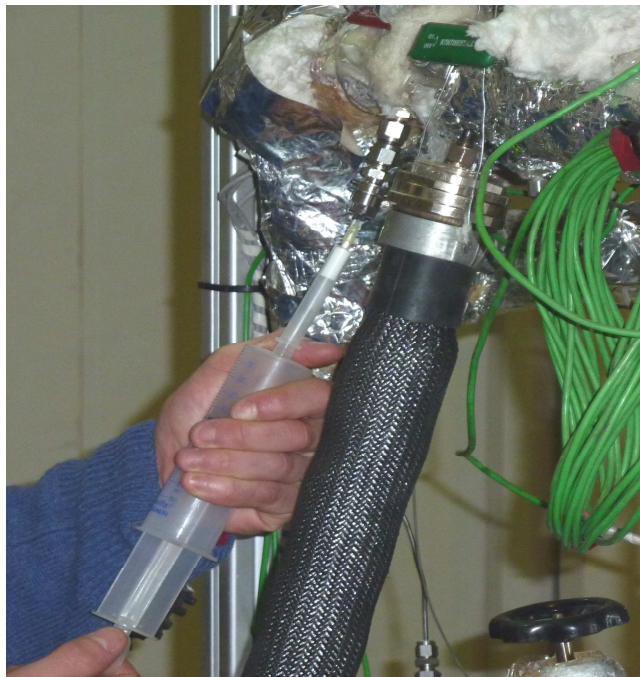
Abbildung 4.2.: Durchführung einer SPA Teerprobennahme am IWT Vergaser
