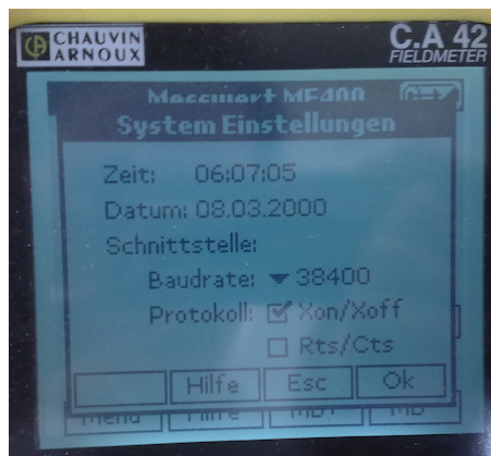
Abbildung 3.3: Verbindungseinstellungen am Feldstärkemessgerät C.A 42
