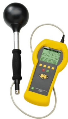
(a) Chauvin Arnoux C.A 42 Feldstärke- messgerät
