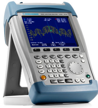
Abbildung 3.6: Spektrumanalysator Rohde&Schwarz FSH3
