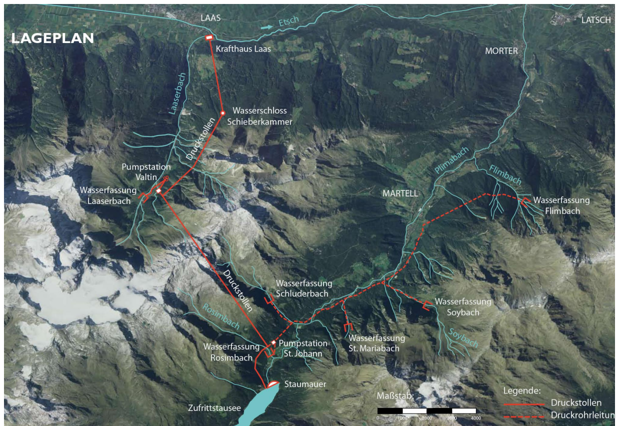
Abbildung 60: Lageplan Kraftwerk Laas, Quelle (SEL AG, 2010 (b))
