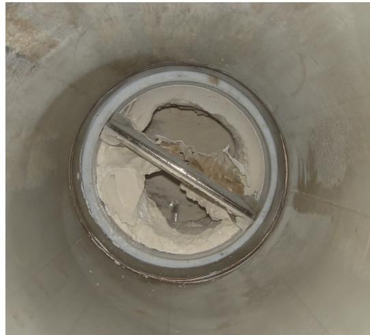
**Abbildung 4-16: Anbackung im Schleusenrohr**
