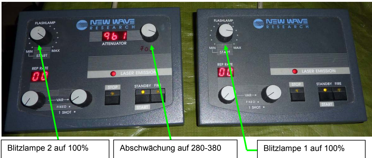
Abbildung 58: Einstellungen für die Lasersteuereinheiten
