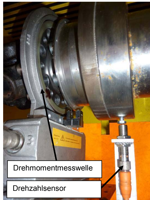
Abbildung 21: Messpositionen für Drehmoment und Drehzahl
