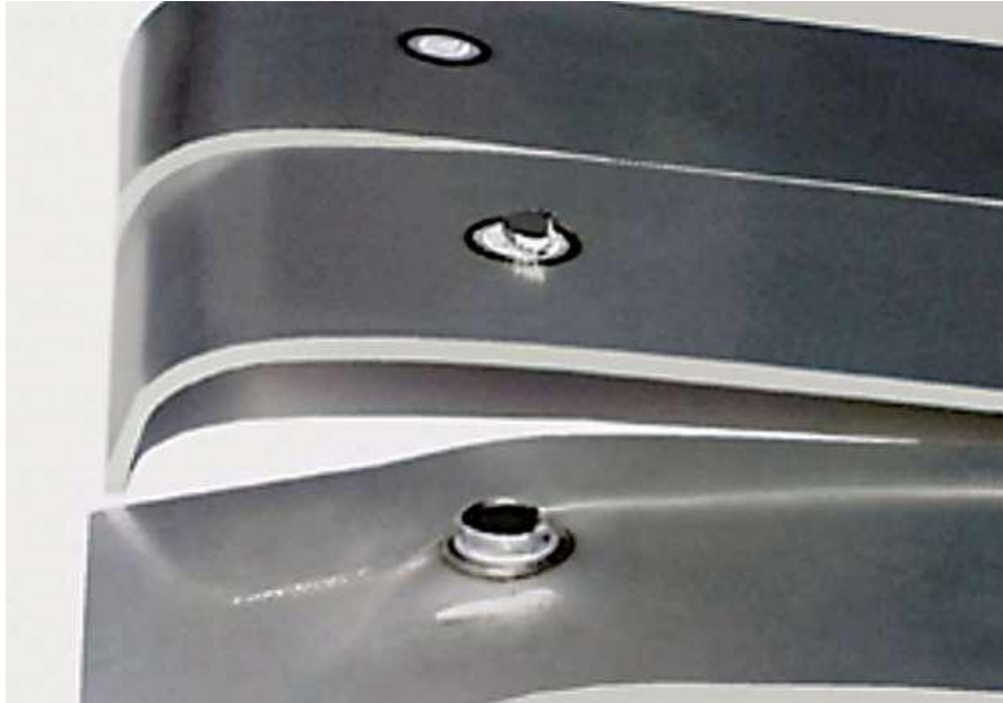
Abbildung 1-1: Bruchformen: Scherbruch, Mischbruch und Ausknöpfbrech (von oben nach unten) [4]
