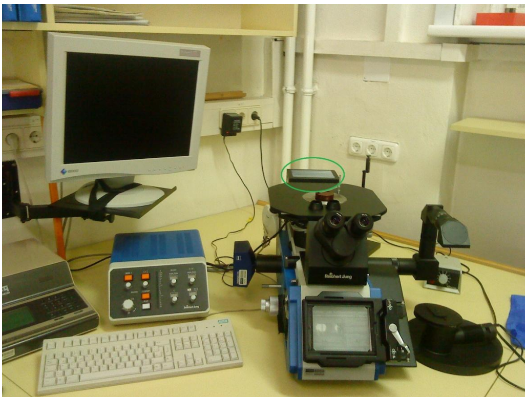
Abbildung 4-40: Lichtmikroskop (Reichert-Jung, MeF3) mit aufgesetztem Mikrohärtprüfgerät (grüner Kreis)
