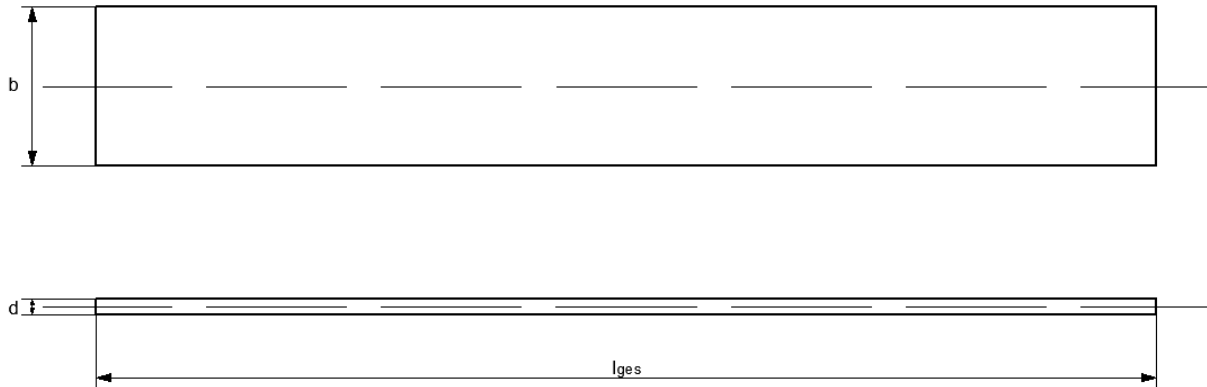
Abbildung 4-12: Flachzugprobe für Gleeble Warmzugversuche (vgl. Formel 4-2)
