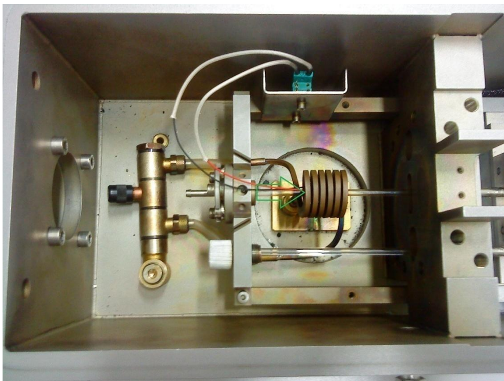
Abbildung 4-44: Eingebaute Dilatometerprobe (siehe Pfeil) in der Prüfkammer des Dilatometers
