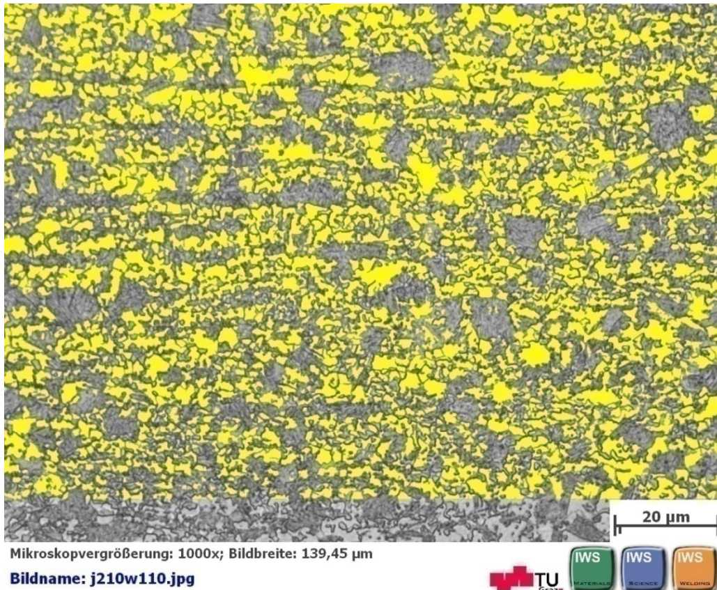
Abbildung 4-38: Flächenauswertung (Gefüge: gelb eingefärbt Ferrit - grau Martensit)
