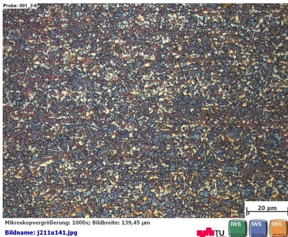
Abbildung 4-59: Gefügebild der Probe: 001_2-6 (1.000-fach), Ferrit, Bainit und Martensit
