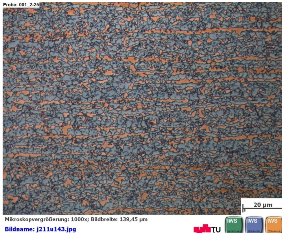
Abbildung 4-58: Gefügebild der Probe: 001_2-25 (1.000-fach), Ferrit und Martensit
