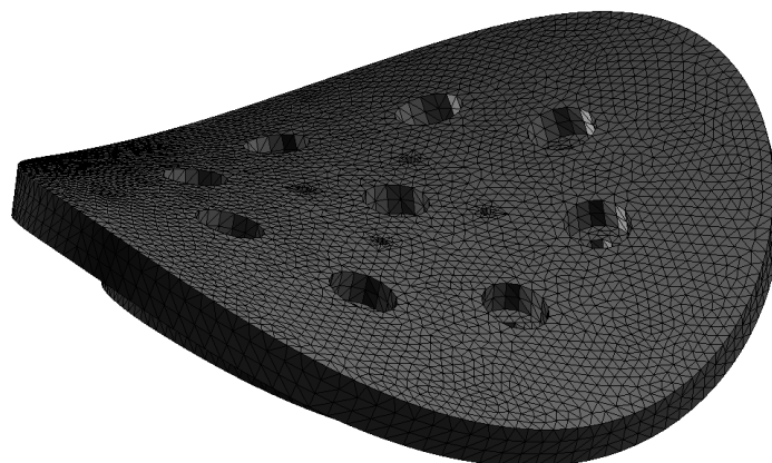
Abbildung 46: 1. Eigenform der Aufspannplatte
