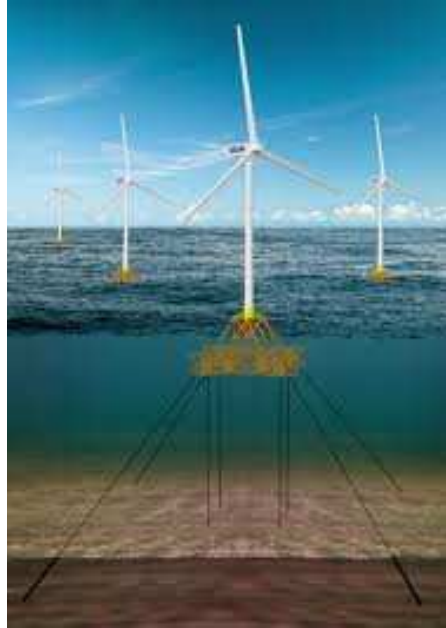
Abbildung 4.32 Prinzip eines schwimmenden Fundamentes [4.32]
