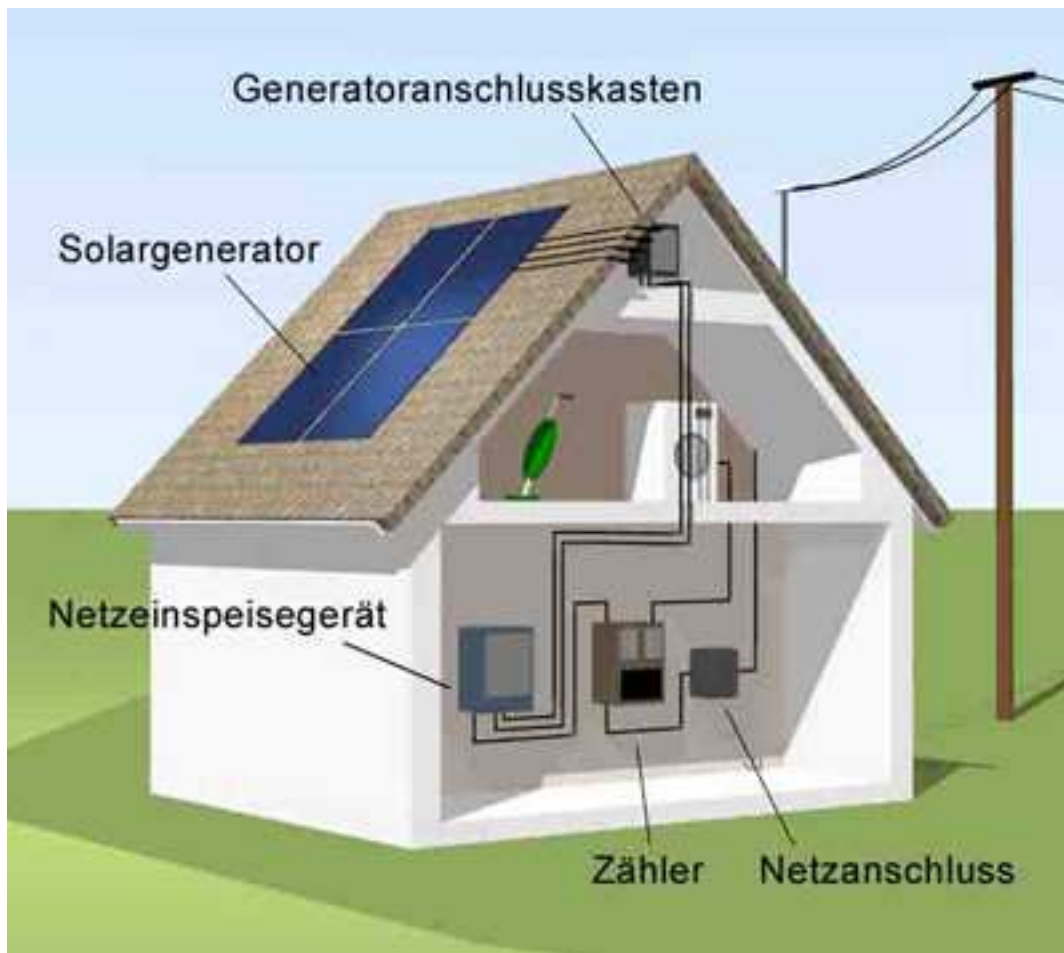
Abbildung 3.3 Schema einer Solarhausanlage mit Netzanschluss [3.3]
