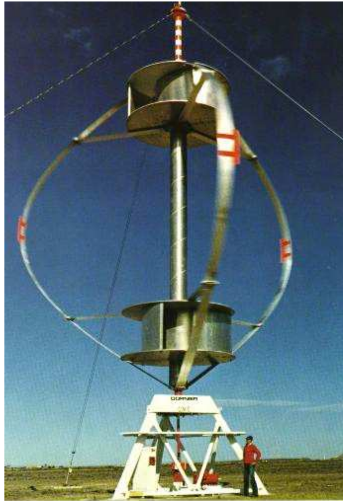
Abbildung 4.4 Der Darrieus-Rotor mit zwei Savonius-Rotoren als Anlaufhilfe [4.4]
