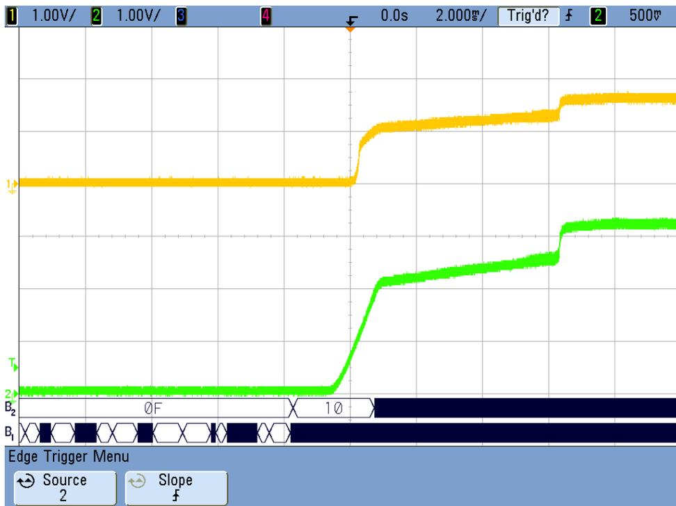
Abbildung 6.2.: Startrampe auf 3,3 V bei 254 mA Laststrom, Zeitachse 2 ms/div
