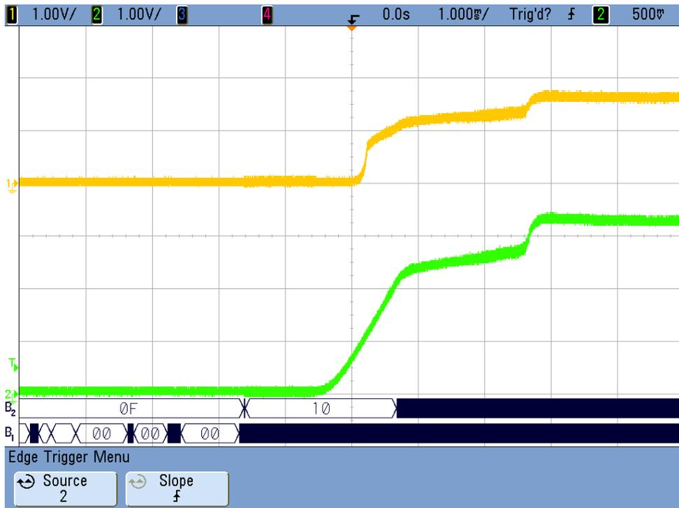
Abbildung 6.1.: Startrampe auf 3,3 V, Zeitachse 1 ms/div
