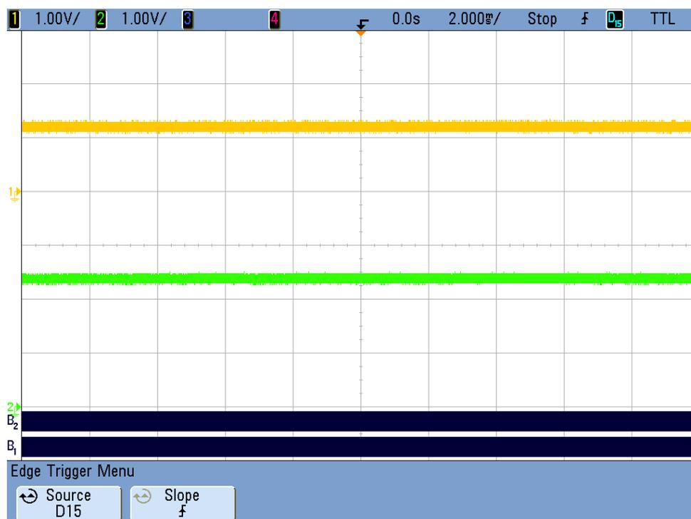
Abbildung 6.5.: Eingeschwungener Zustand nach 2 min, 254 mA Laststrom, Zeitachse 2 ms/div
