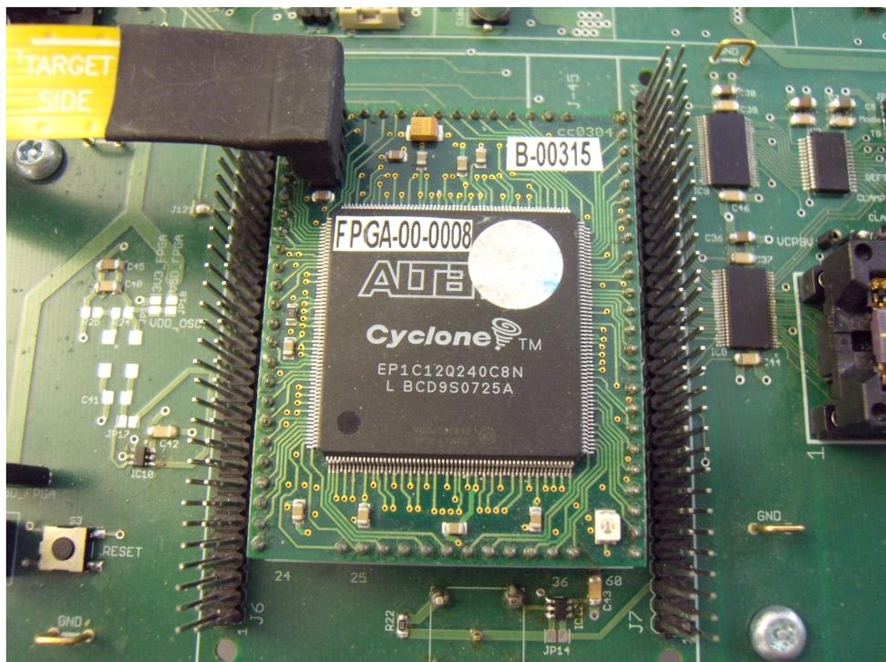
Abbildung 4.7.: Das eingesetzte FPGA-Modul von Altera
