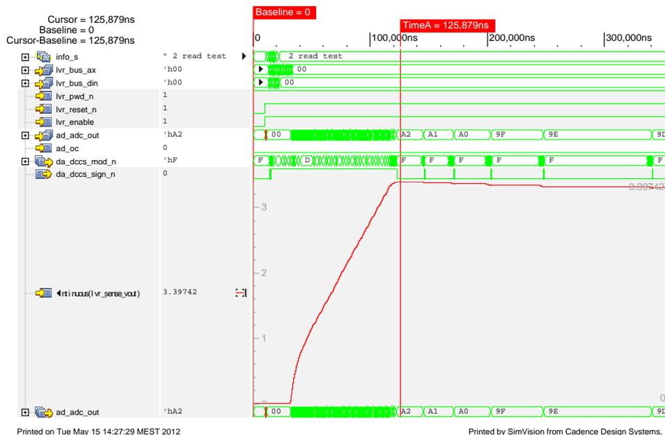
Abbildung 5.2.: Startrampe der Ausgangsspannung
