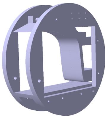
(a) Konstruierter Versuchseinsatz
