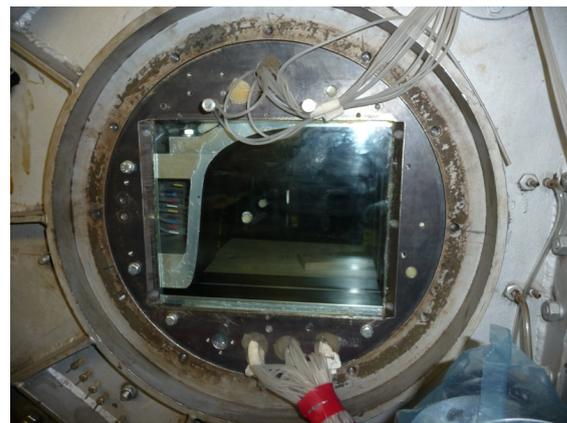
(b) Foto - Versuchseinsatz eingebaut in den transsonischen Prüfstand, mit Druckmessschläuchen
