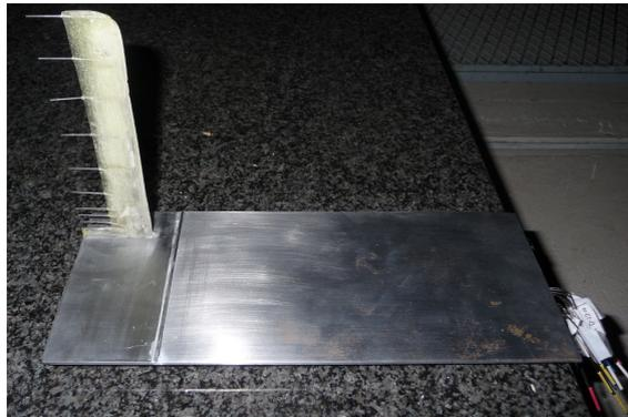
Abbildung 4.6: Foto - Einlaufplatte mit Totaldruckmessbaum und Stolperdraht
