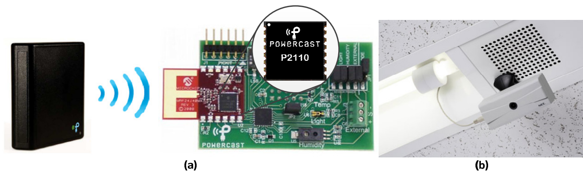
Abbildung 27: (a) Powercast Evaluierungsboard zur drahtlosen Energie- und Datenübertragung [34]. (b) Überwachungskamera von NEC, gespeist durch eine Leuchtstoffröhre [35].
