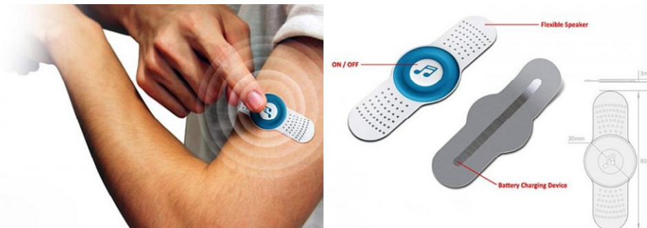
Abbildung 65: MP3 Player in Pflasterausführung mit integriertem Lautsprecher und thermoelektrischem Versorgungskonzept [81].
