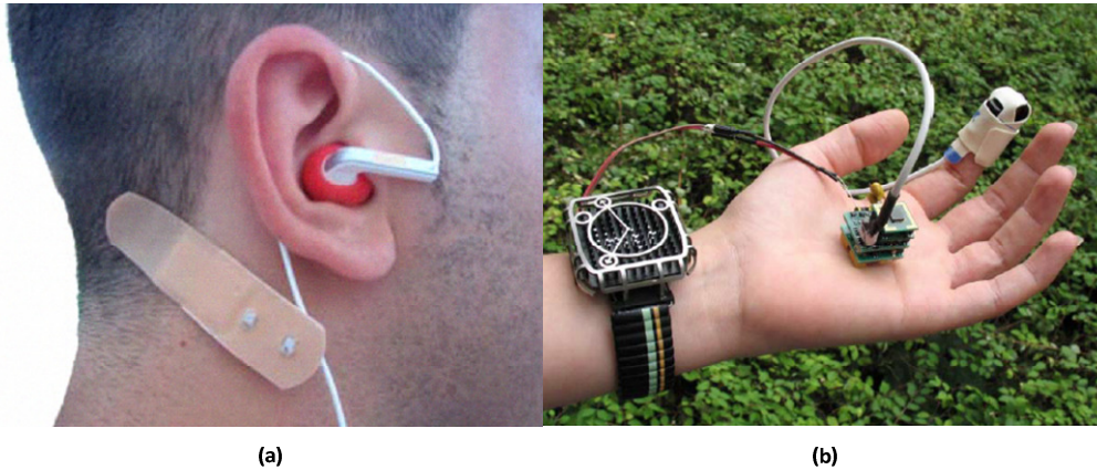
Abbildung 66: (a) Demonstrator eines thermoelektrischen Hörgerätes [82] (b) Handelsübliches Puls Oximeter, welches durch einen als Uhr ausgeführten Thermogenerator seine Energie erhält. Der Generator liegt direkt über der Radialis Arterie, wodurch ständig Blut aus dem Körperkern als Wärmequelle fungiert [83].
