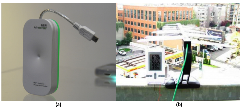
Abbildung 26: (a) Auf der CES2010 vorgestellter Wlan Harvester von RCA [32]. (b) Versorgung eines Thermo-/Hygrometers aus dem Rundfunksignal eines 4,1km entfernten Senders [31].
