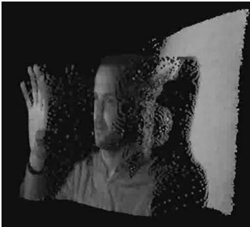
Abbildung 6.22: Dreidimensionale Aufnahme einer TOF-Kamera [TOF-Kamera 2010]
