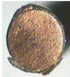
Abbildung 4.7 Querschnitt durch einen lackisolierten Draht [24]
