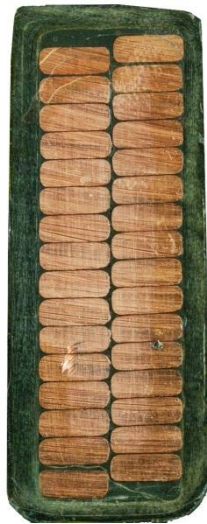
Abbildung 4.9 Querschnitt eines realen Generatorstabes
