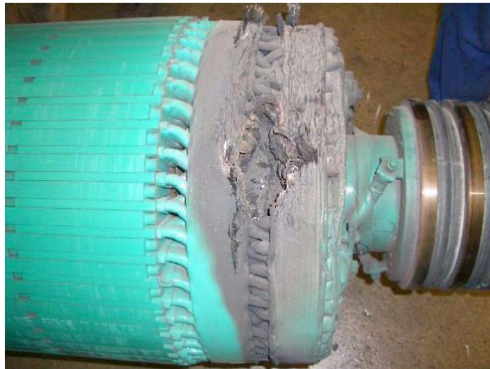
Abbildung 6.8 Beispiel eines Ausfalls der Windungsisolierung [70]
