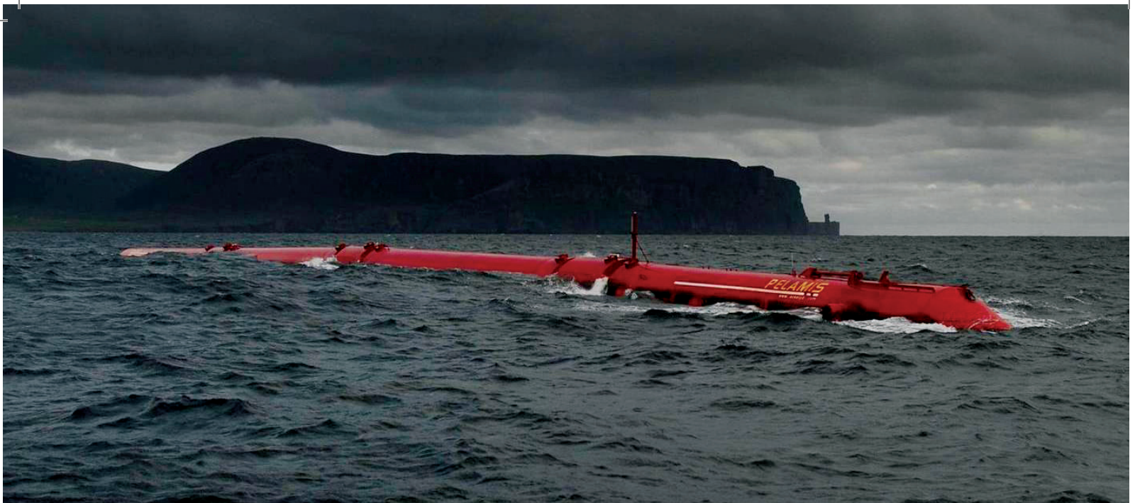
Oben: Pelamis Wellengenerator, ein Prototyp vor der Küste Schottlands 1
