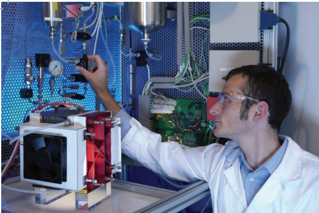
Oben: Reversible Wassertstoffbrennstoffzelle 1 Rechts: Meerwasserentsalzungsanlage 2
