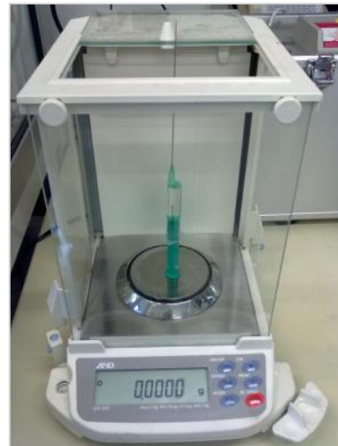
Abbildung 5.3-14: Waage und Spritze mit langer Nadel (inkl. einer Probe) [eigenes Photo]
