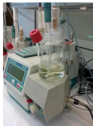
Abbildung 5.3-18: 831 KF-Coulometer 831, Magnetrührer und Titrierzelle [eigenes Photo]
