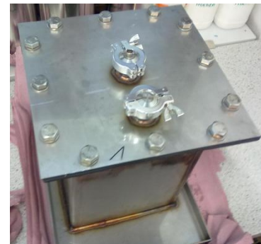
(Prüfgefäß inkl. Prüfling zusammengebaut)
