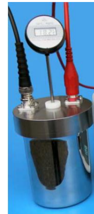
Abbildung 2.2-3: Photo von einer Messzelle für Flüssigkeiten [80]
