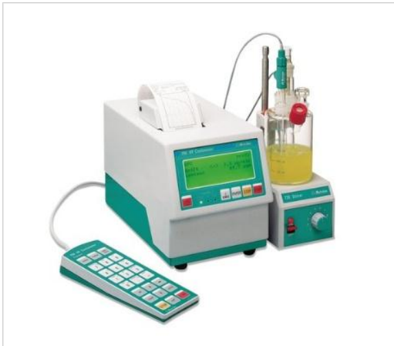
Abbildung 5.3-13: 831 KF Coulometer, Titriergefäß, Magnetrührer, Tastatur [84]
