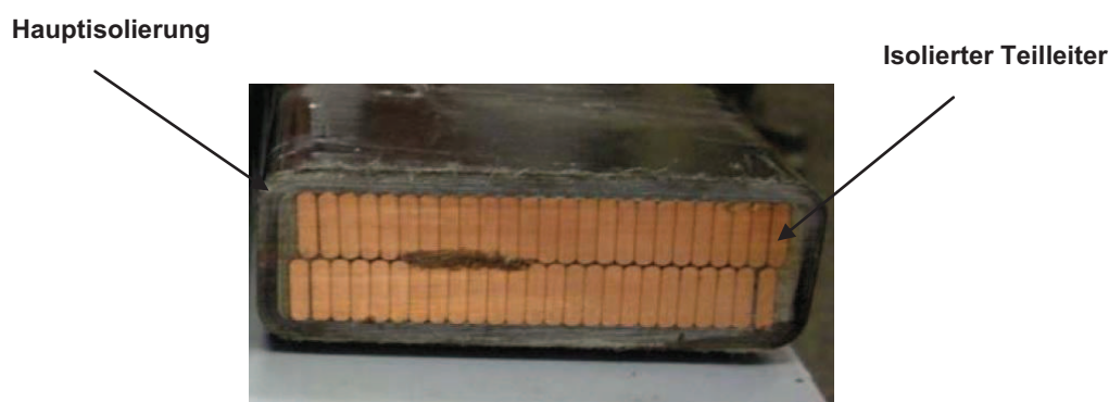
Abbildung 28 Aufbau Wickelstab [16]
