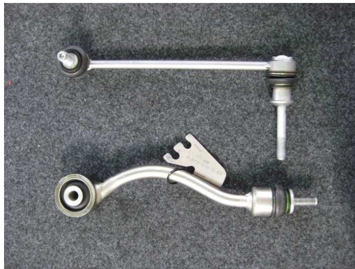
Abb. 4.13: Koppelstangen, oben Typ 1, unten Typ 2
