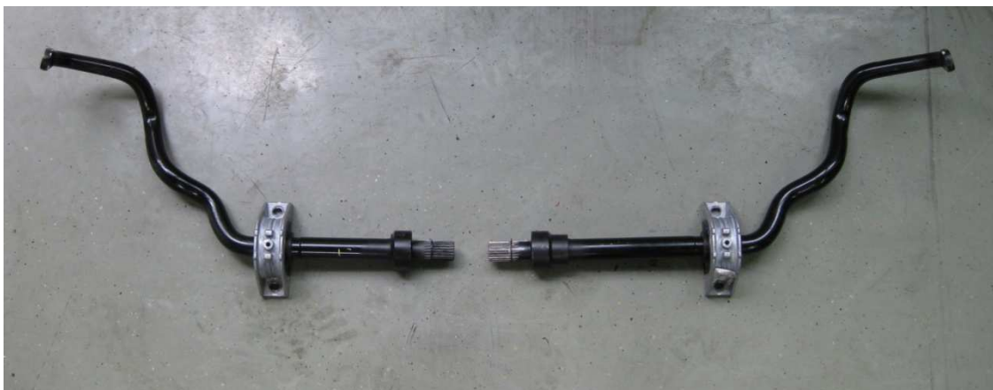
Abb. 4.12: Typ 1 Stabilisator-Arme mit aufgeschweißten Adaptern mit Steckverzahnung
