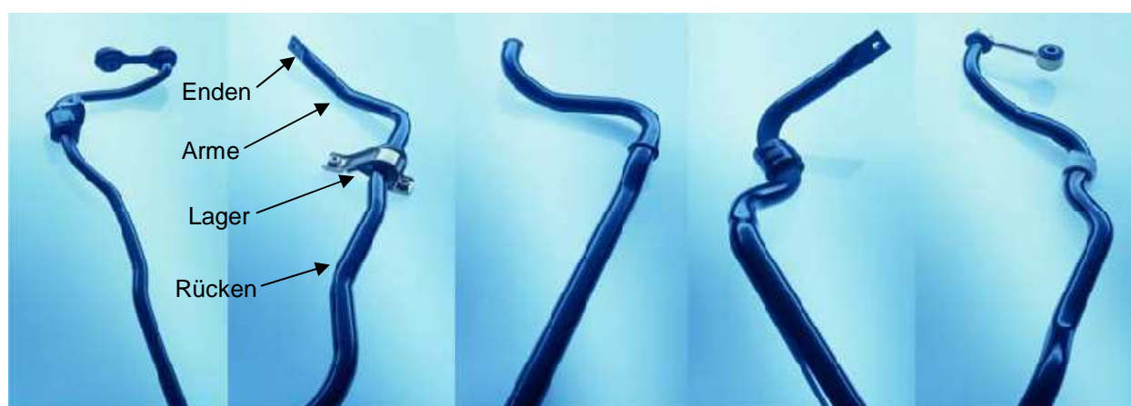
Abb. 3.1: Beispiele für PKW-Stabilisatoren [1]
