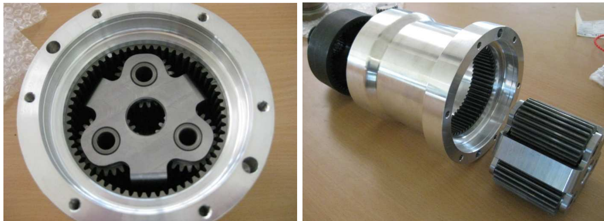
Abb. 4.9: Draufsicht und zerlegtes Wolfom-Getriebe
