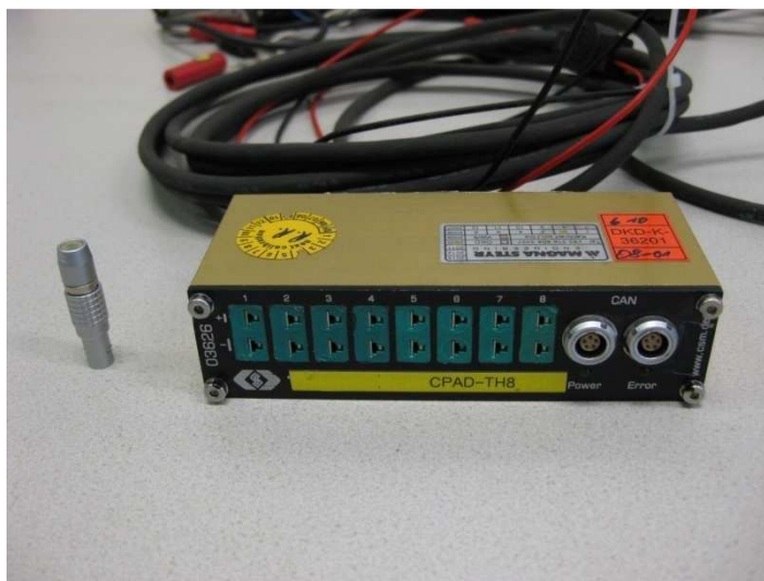
Abb. 5.7: CSM Modul für die Signale der Thermoelemente und Anschluss an den CAN
