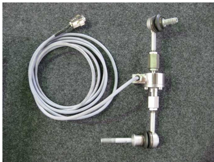
Abb. 4.14: Koppelstange mit integrierter KMD
