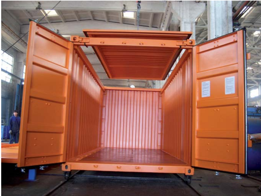
Abb. 4.2.3/1: ISO-Container 45' highcube als ,open-top-container'
