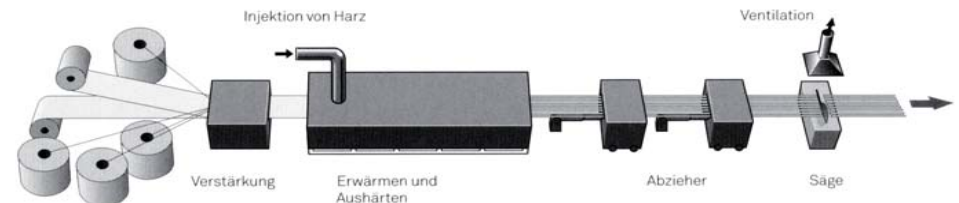
Abb. 4.2.8.2/3: Bauteilherstellung im Pultrusionsverfahren
