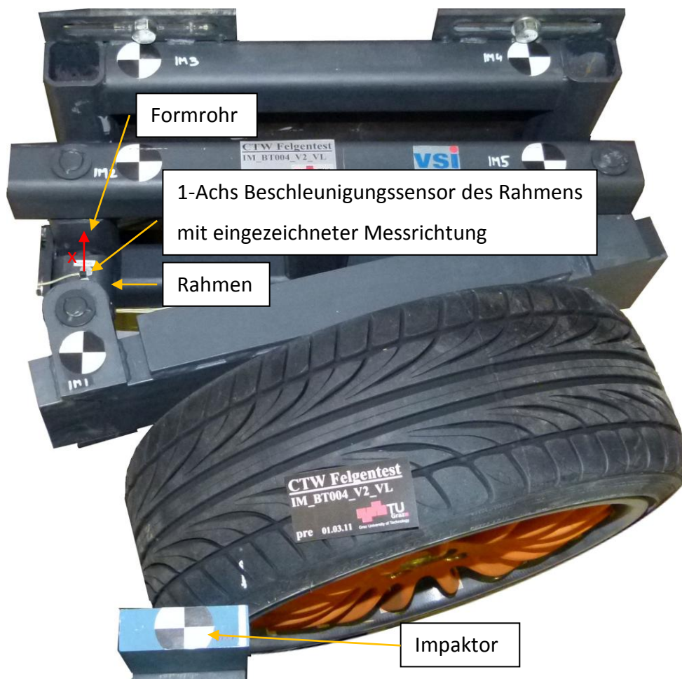
Abbildung 7-4: Position des Rahmen-Beschleunigungssensors beim Impact-Test
