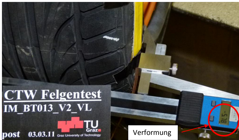
Abbildung 7-13: Auswertung der Verschiebung des Felgenbettes zum Prüfaufbau (IM_BT013_V2_VL)
