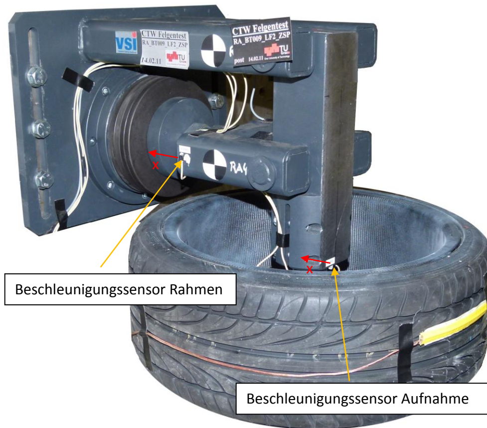
Abbildung 7-15: Position der Beschleunigungssensoren am Radialschlagprüfstand
