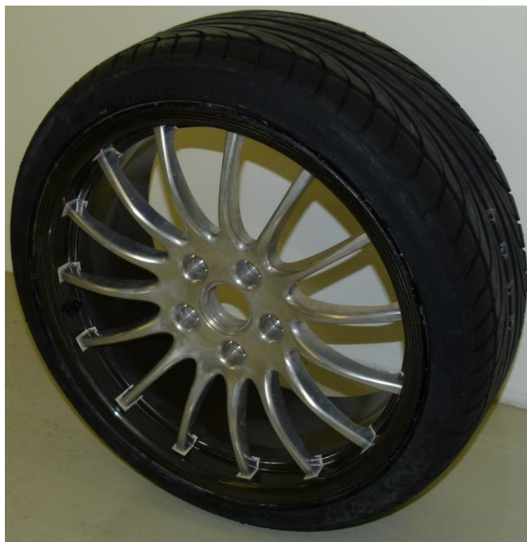
Abbildung 7-1: R20_020_000 CFK-Al-Hybridfelge mit Bereifung - Falken FK452 in der Dimension 245/35ZR20 – 95Y
