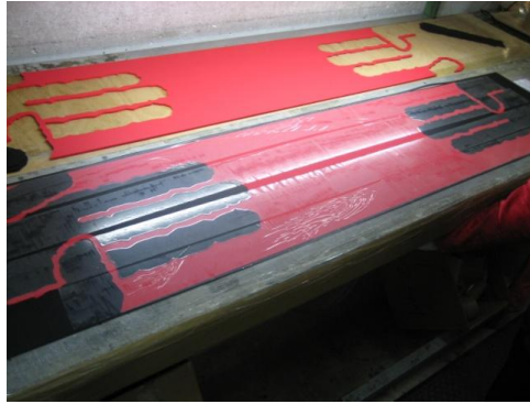
Abbildung 4-39: Fixierung der Einzelteile mittels Klebeband
