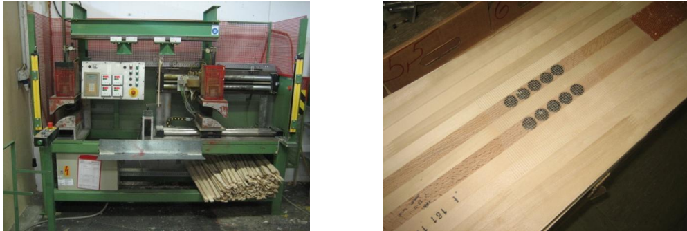
Abbildung 4-23: Biegevorrichtung (links), Holzkerne (rechts)
