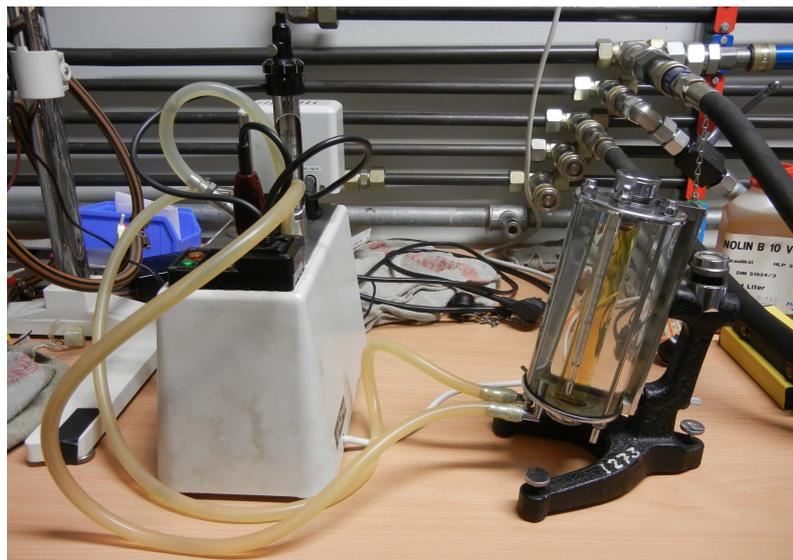
**Abbildung 7.4** – Messaufbau Kugelfallviskosimeter
