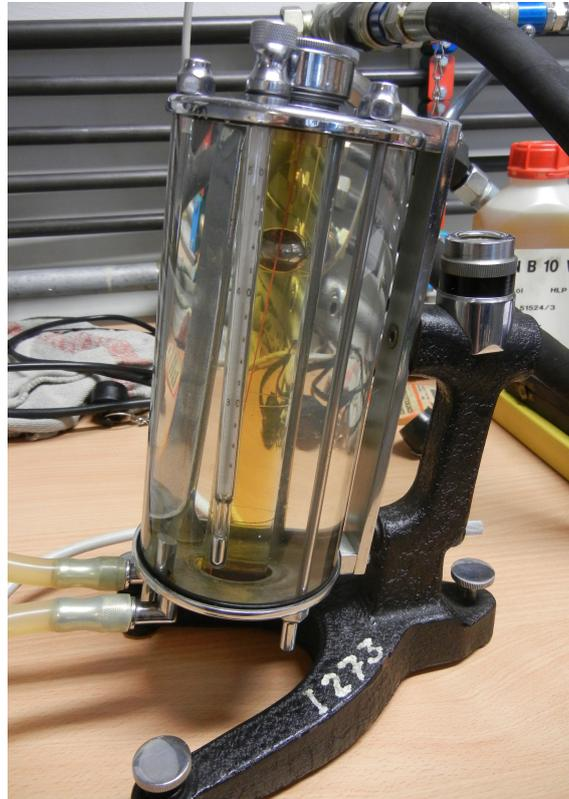
Abbildung 7.5 – Kugelfallviskosimeter
