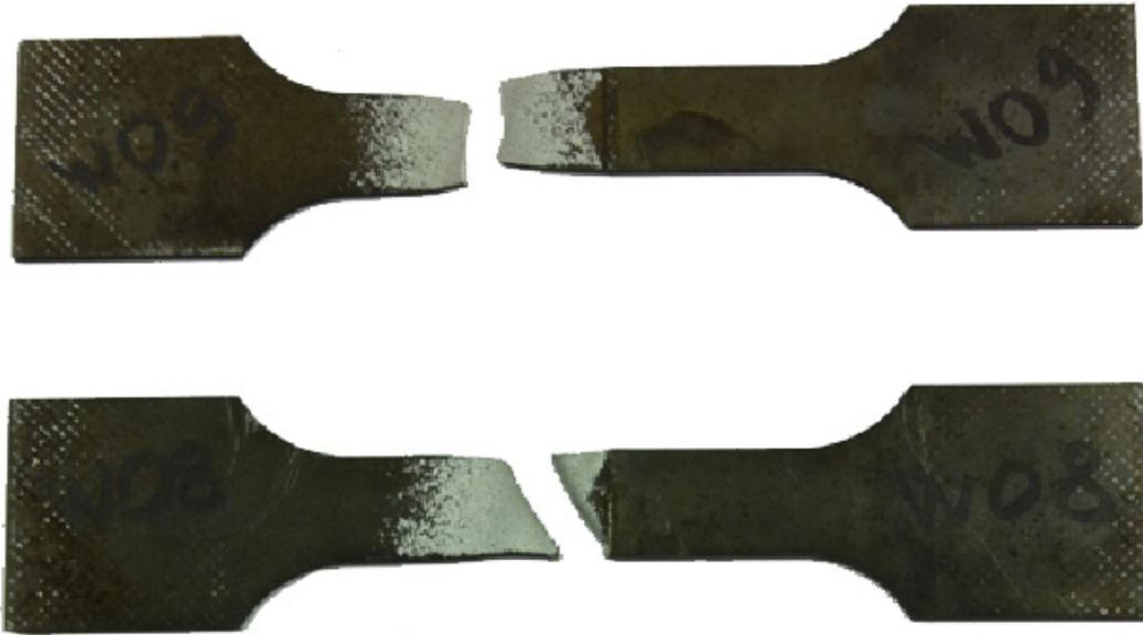
Abbildung 5.35 Zugprobe mit LPW4140
