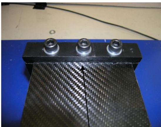
Bruch bei Einspannung
