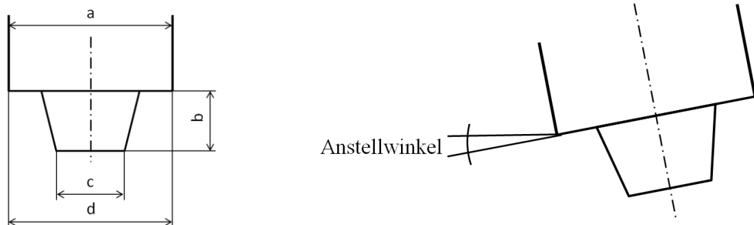
Abb 22: links: Schematische Darstellung des Werkzeuges rechts: Einspannsituation des Werkzeuges
