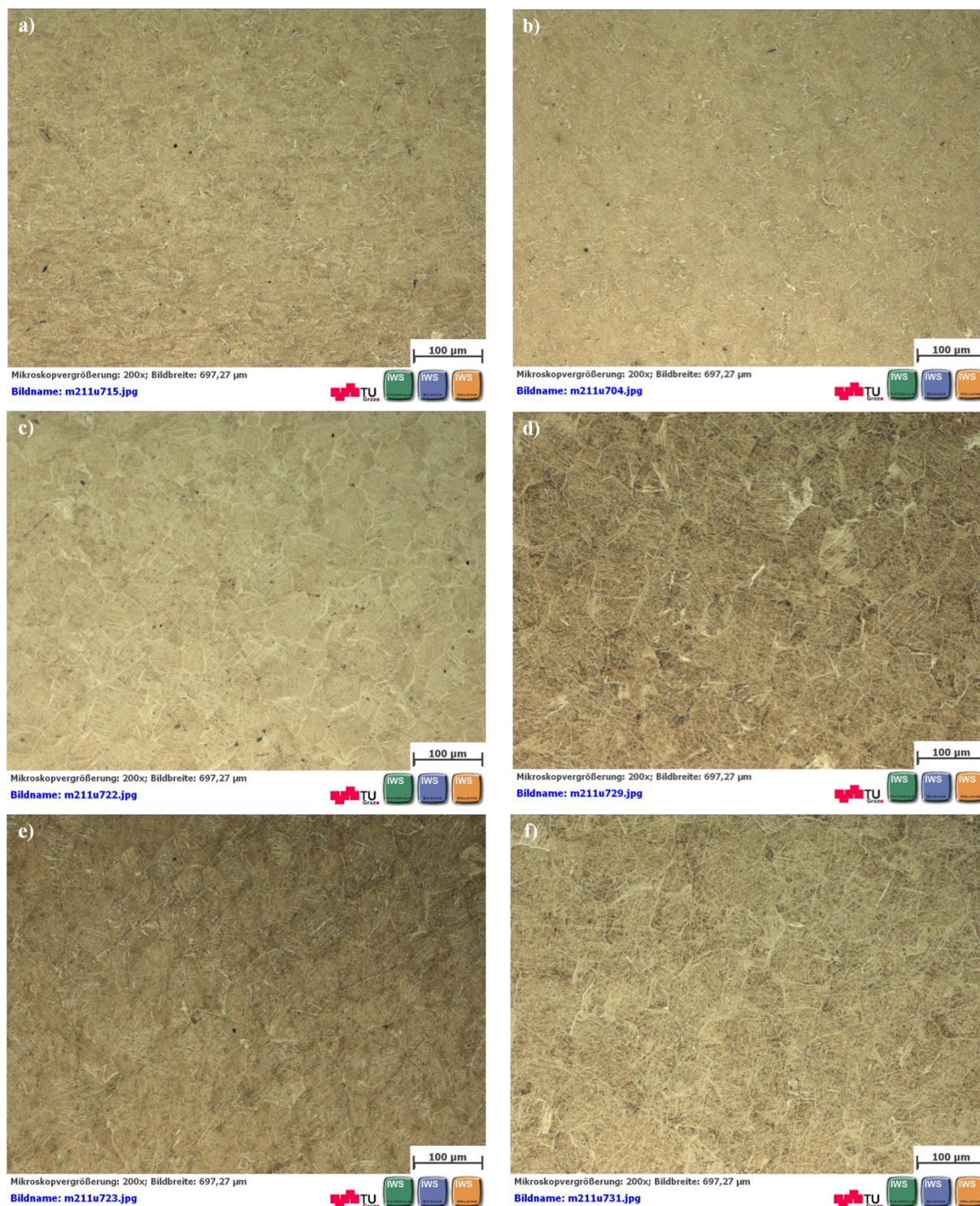
Abb 46: \beta -Korngrößenentwicklung 200fache Vergrößerung a) S008 (300 rpm) b) S007(350 rpm) c) S010(450 rpm) d) S013 (500 rpm) e) S009 (600 rpm) e) S009 (600 rpm) f) S011 (650 rpm)
