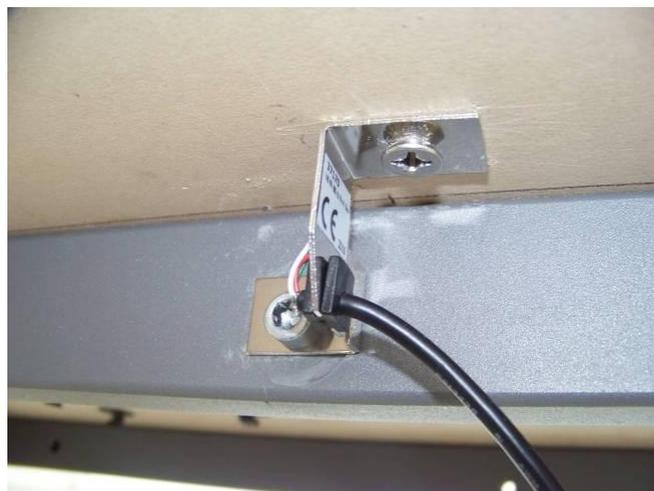
**Abbildung 3.3: Metallbügel mit appliziertem Dehnungsmessstreifen (aus [2]); wirkt eine äußere Kraft auf die Tischplatte ein verspannt sie sich gegen den metallischen Unterbau (quadratisches Formrohr); dadurch verspannt sich auch der Metallbügel und der DMS wird gestaucht oder gedehnt**
