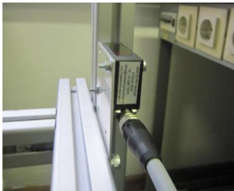
**Abbildung 6.9: Lasertriangulationssensor am Item-Profilrahmen montiert**
