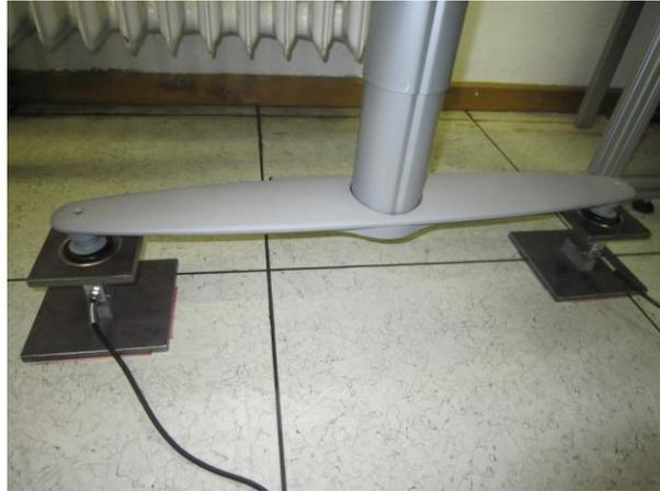
**Abbildung 6.2:** Wägezellen zur Gewichtsmessung unter dem Ausleger des teleskopartigen Tischbeins
