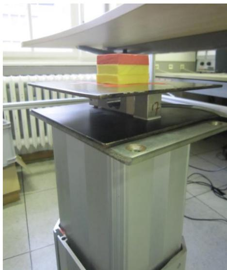
Abbildung 6.5: Wägezelle zur Messung der Kontaktkraft; die Wägezelle steht auf einer massiven, höhenverstellbaren Säule; ein Schaumstoffprüfling kann zur Simulation von Quetschungen mit weichen Objekten eingesetzt werden
