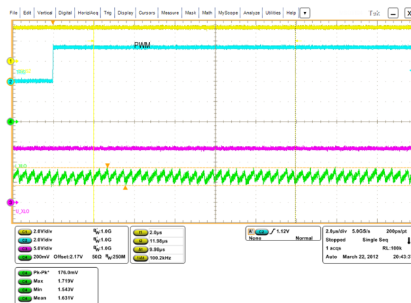
Abbildung 6.10: Stromverlauf während der Limitierung (2-Punkt, automatisiertes Testverfahren)
