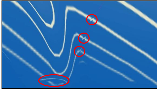
Abbildung 5.5: Punktstetige Stellen auf einer aufbereiteten Karosseriefläche
