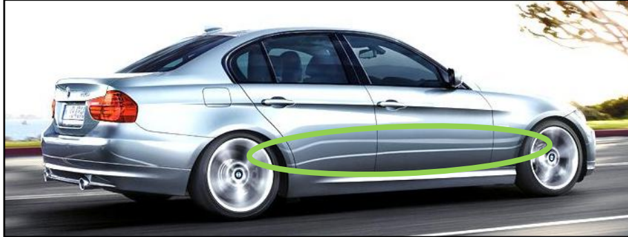
Abbildung 5.3: Tangential stetige Lichtreflexionen an einem Serien-PKW, [22]
