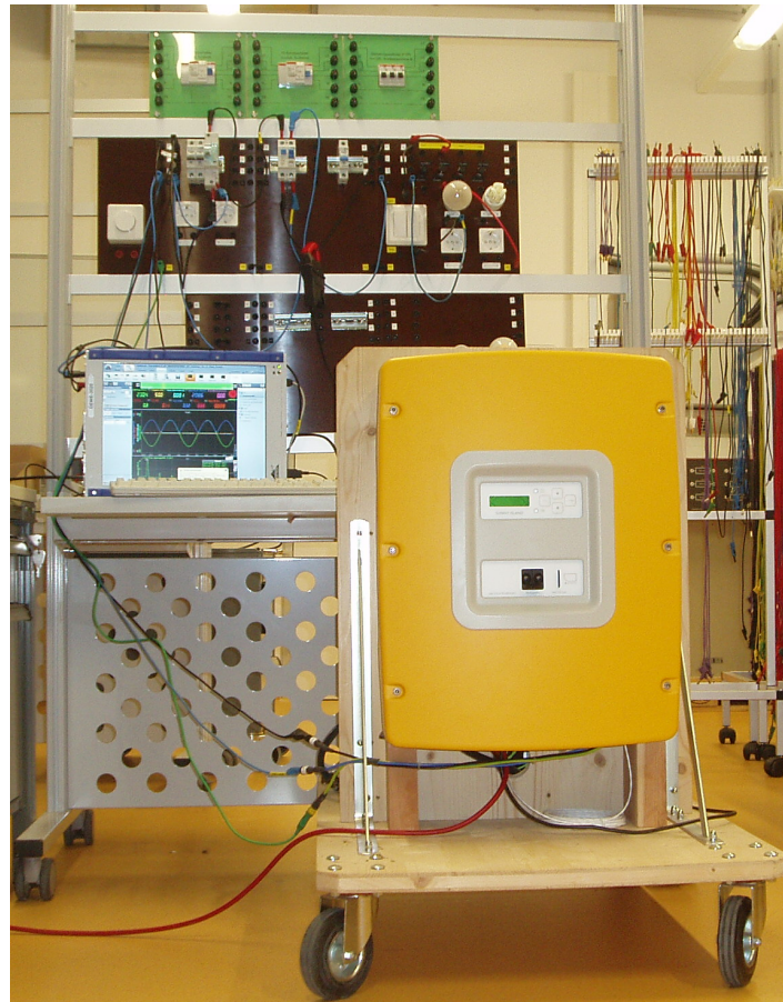
Abbildung 7.4: Wechselrichter SI 5048 und modulares Inselnetzmodell zur Untersuchung der Schutzkomponenten
