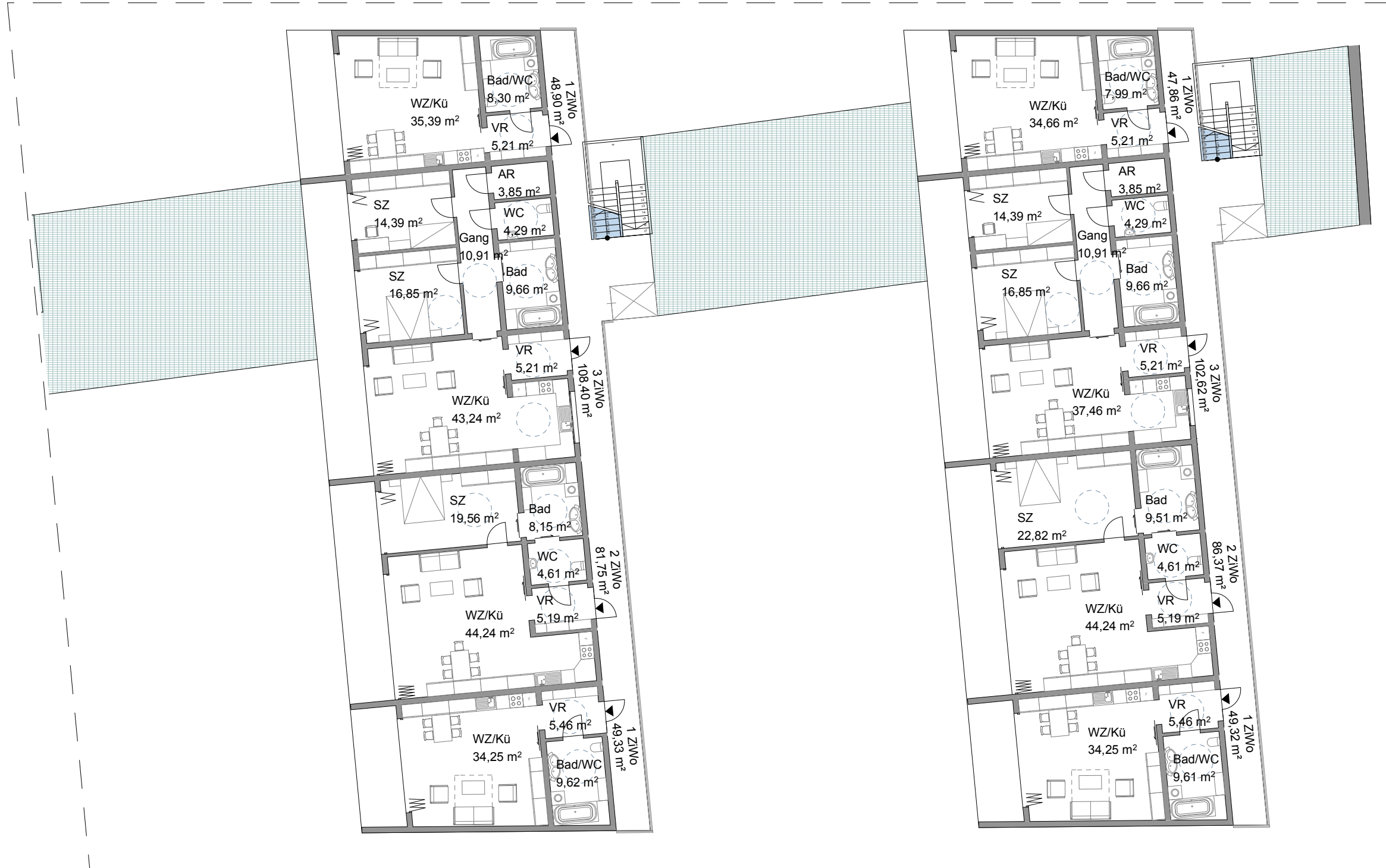
GRUNDRISS 2. OBERGESCHOSS Teil 02 M 1:200
