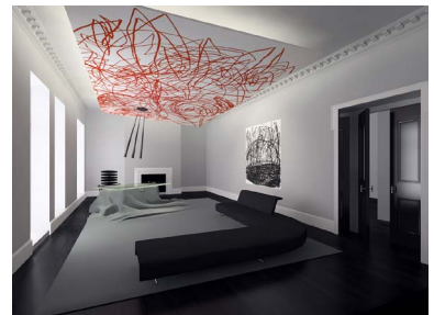
Abb. 145 Innenraum-Rendering 2010. Die Kamera befindet sich eigentlich hinter der Rückwand im nächsten Raum (um kein extremes Weitwinkel verwenden zu müssen). Die Wand ist zwar vorhanden und wird für GI-Berechnungen verwendet, nur ist sie nicht sichtbar.
