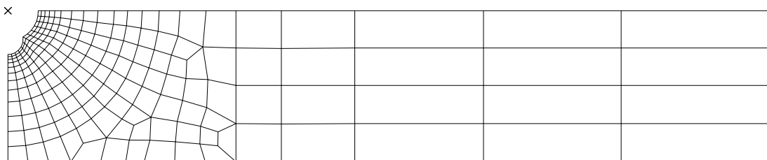
Bild 37: Finite Elemente Modell des Flachstabs mit der Kerbformzahl \alpha_K=3,6
