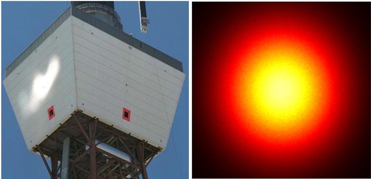
**Abbildung 4.5:** Form des reflektierten Abbildes eines Solar Two Heliostaten auf der Messplattform zur Bestimmung des Nachführungsfehlers [51] (links) und aus den Simulationen eines Heliostaten in Raytrace3D (rechts)
