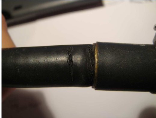
(a) Risse in der Ummantelung des Heckrotorkabels
