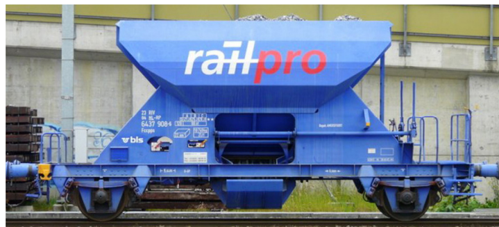
Abbildung 1-1: 2-achsiger Güterwagen der Gattung „F“ - Firma railpro GmbH 5
