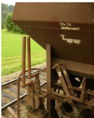
Abbildung 1-2: Hebelmechanismus geschlossen (links) und Dosierung (rechts) 6
