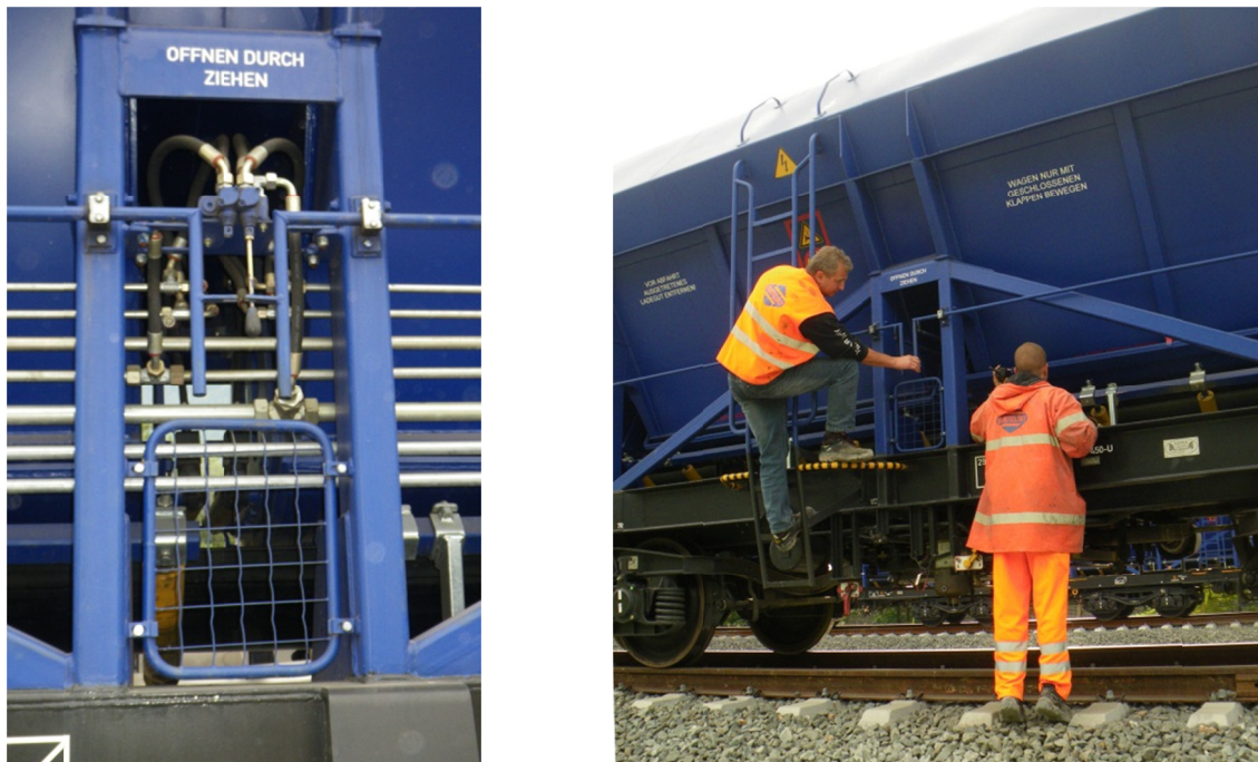
Abbildung 1-6: Hebelmechanismus inklusive Hydraulik (links) und Dosierung (rechts) 13
