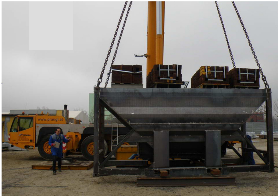
Abbildung 1-17: RockTainer CSC-Zulassung - Hebe-Test 32
