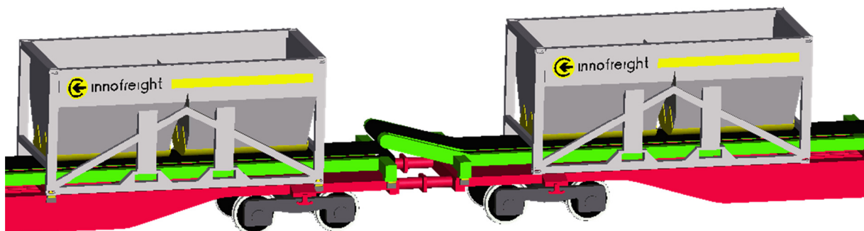
Abbildung 1-10: Schüttgutübergabe zwischen zwei Wagen 19
