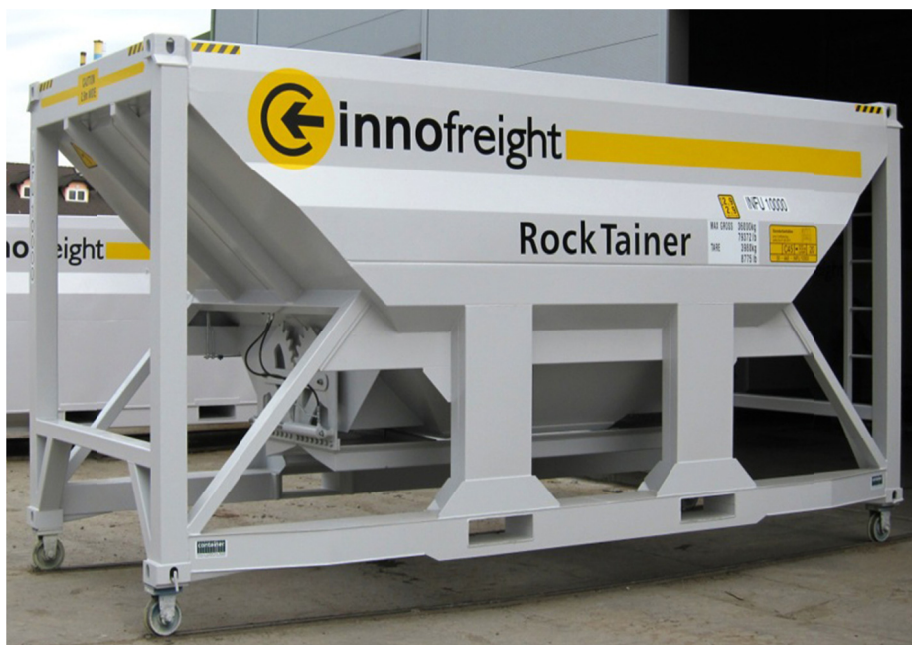
Abbildung 1-18: RockTainer - fertiggestellter Prototyp 33
