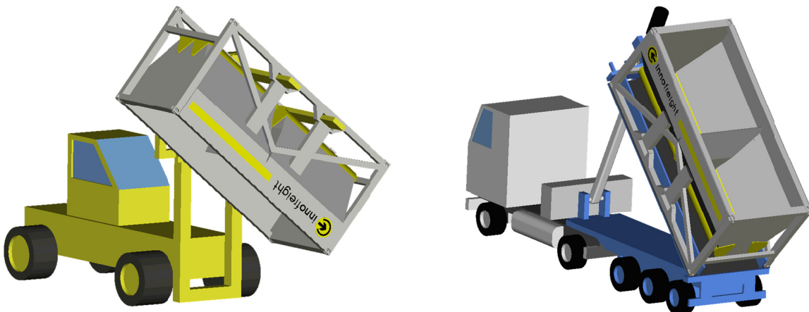
Abbildung 1-12: Drehentladung (links) und Kippentladung (rechts) 21
