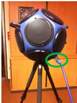
Abbildung 169: Anschluss des Dodekaederlautsprechers an den Verstärker
