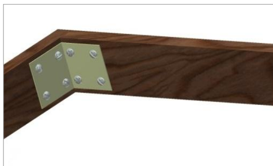
Abbildung 134: Verbindung der Rahmenelemente mit einem Winkel
