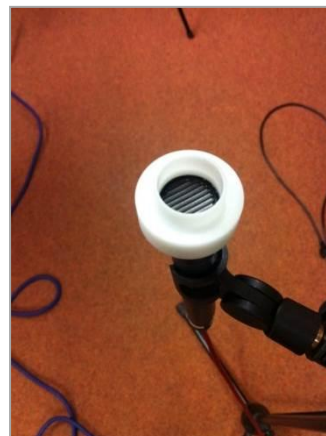
Abbildung 179: Aufsetzen des Kalibrator (links) bzw. Adapter (rechts)
