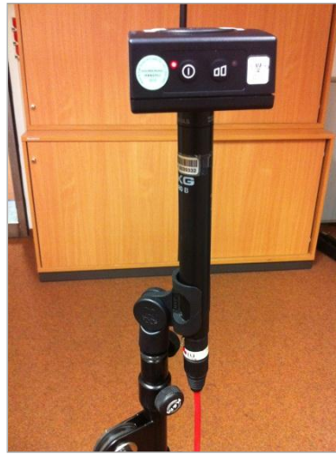
Abbildung 30: Positionierung des Kalibrators über dem Mikrofon
