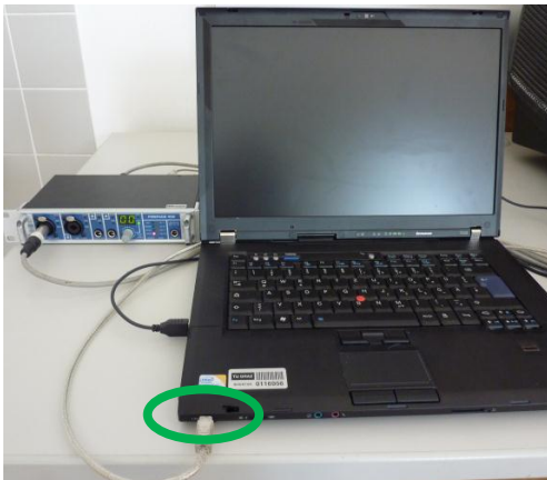
Abbildung 164: Anschluss des PC an das Audio Interface
