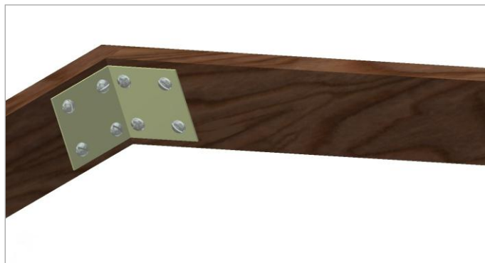
Abbildung 68: Verbindung der Rahmenelemente mit einem Winkel
