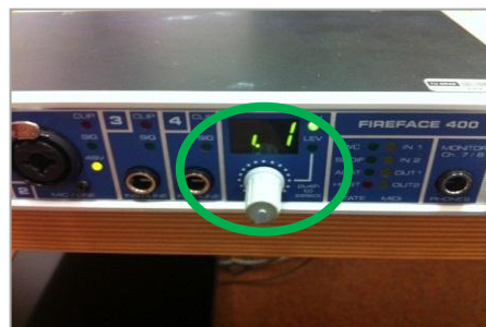
Abbildung 181: Auswahl des Kanals und Einstellung des Input Levels
