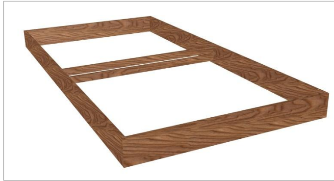
Abbildung 135: Modulrahmen mit Stabilisierungsbalken
