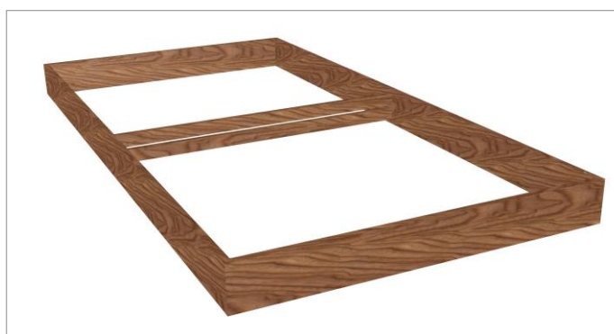
Abbildung 69: Modulrahmen mit Stabilisierungsbalken
