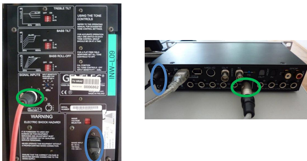
Abbildung 173: Verkabelung des Genelec 1030A mit dem Audio Interface
