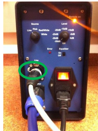
Abbildung 169: Anschluss des Dodekaederlautsprechers an den Verstärker
