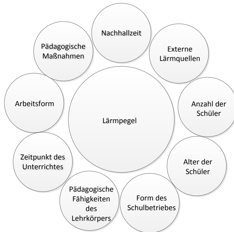
Abbildung 2: Variablen, von denen der Lärmpegel in Klassenräumen abhängig ist [MÜLLER, S.38]
