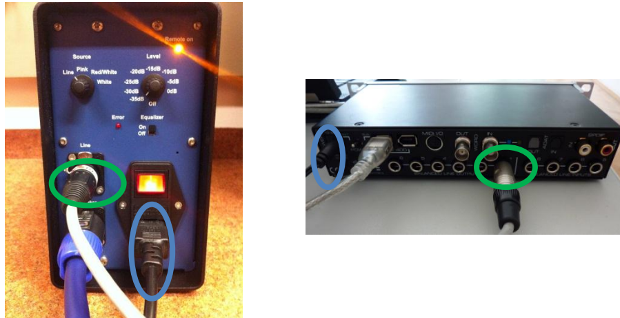
Abbildung 172: Anschluss des Verstärkers an das Audio Interface
