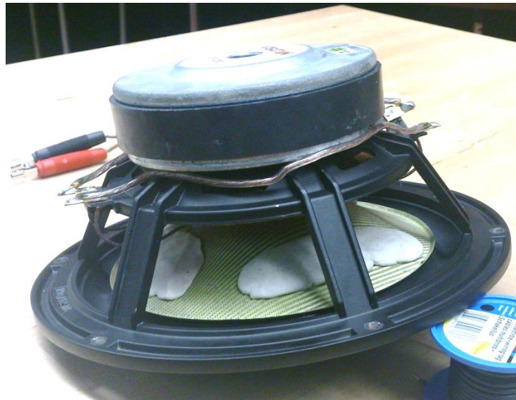
Abb. 3.109: Chassis mit hinter der Membran angebrachter Zusatzmasse
