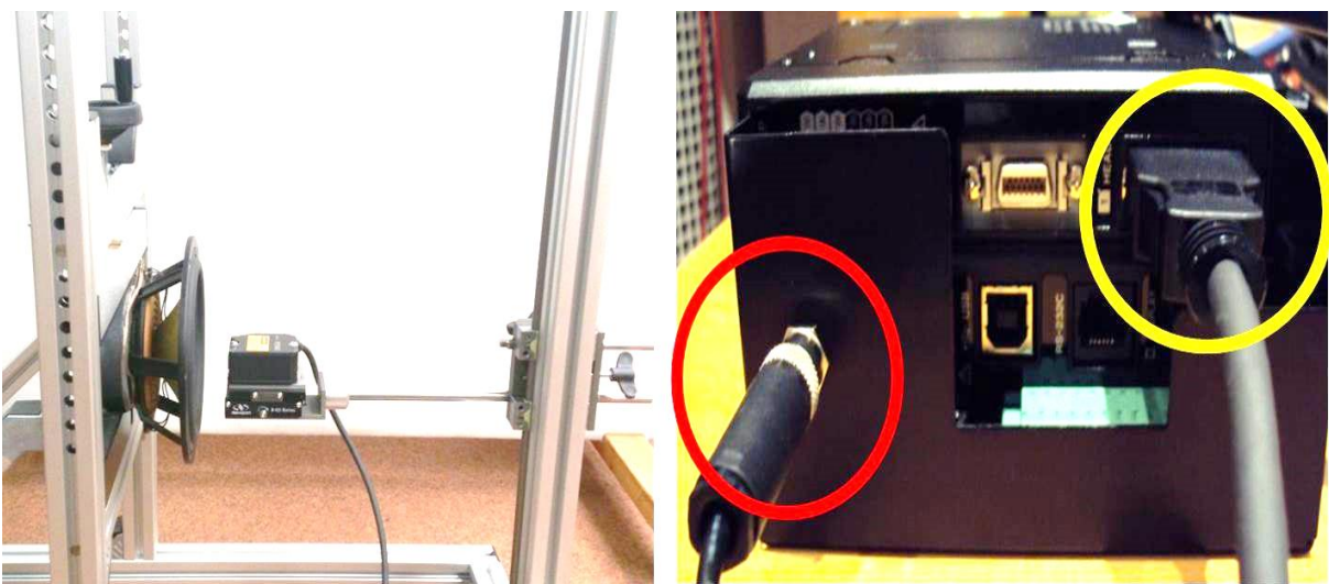
Abb. 3.37: Montierter Laserkopf (links) und Anschlüsse am Laserkontroller (rechts)
