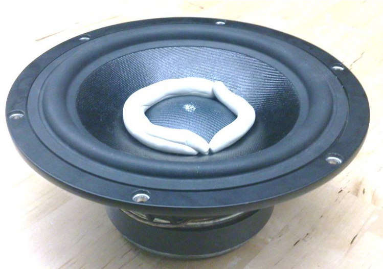
Abb. 3.115: Chassis mit einer vor der Membran angebrachten Zusatzmasse
