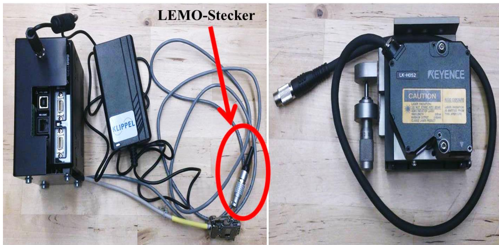
Abb. 3.29: Laserkontroller mit Netzkabel und LEMO-Stecker (links) und Laserkopf (rechts)
