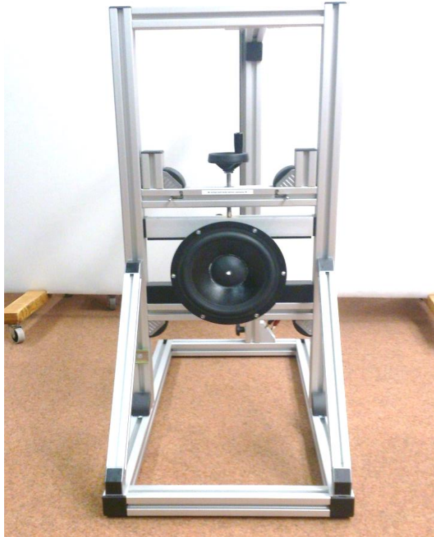
Abb. 3.22: Montage des Testchassis am Montagestand
