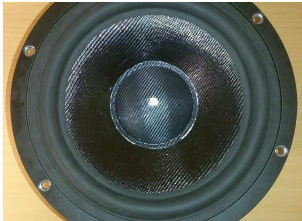
Abb. 3.21: Tieftonchassis GF200 mit weißem Punkt um den Signalrauschabstand des Lasersignals zu verbessern
