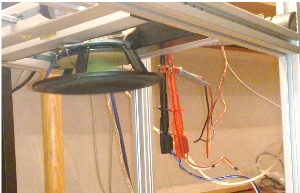
Abb. 3.106: LSI-Messung bei vertikaler Ausrichtung des GF200 (Membran nach unten)
