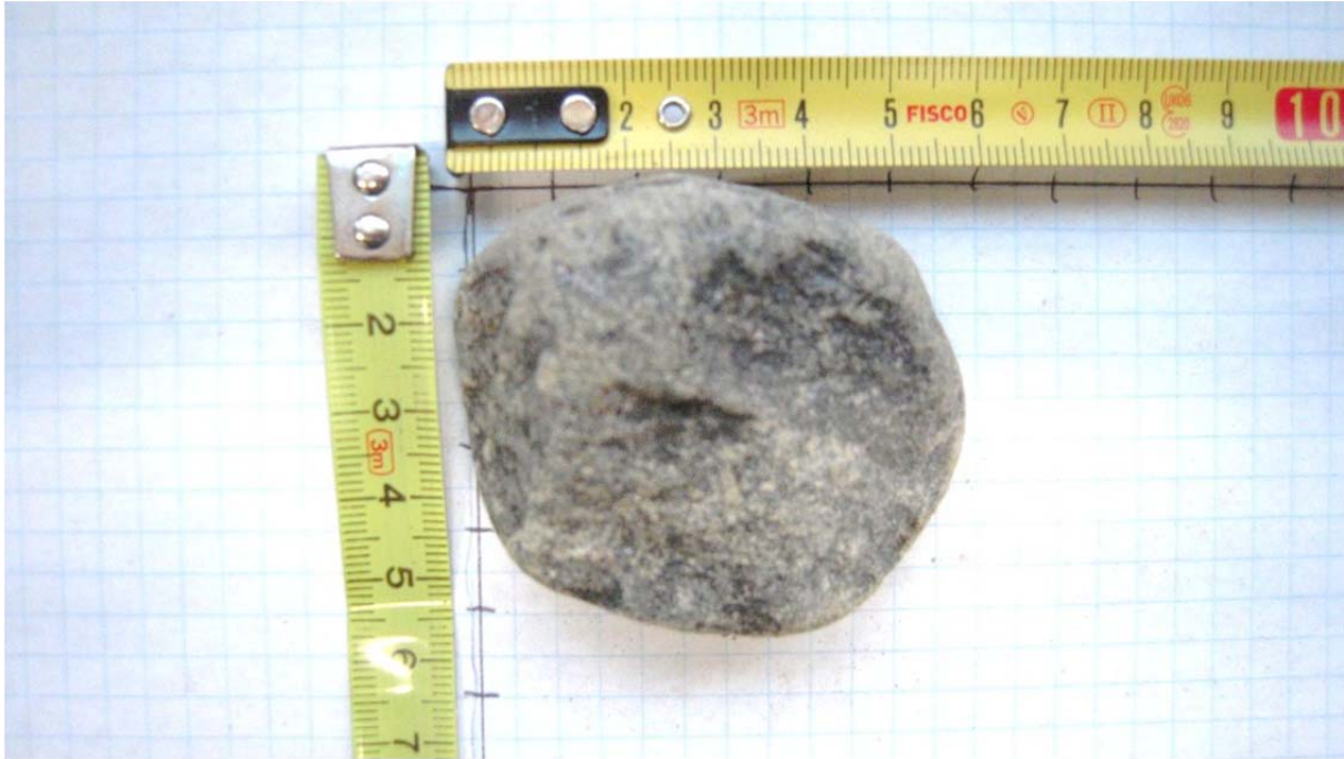
Abbildung 11: Abgeriebene Kanten nach Versuchsdurchführung
