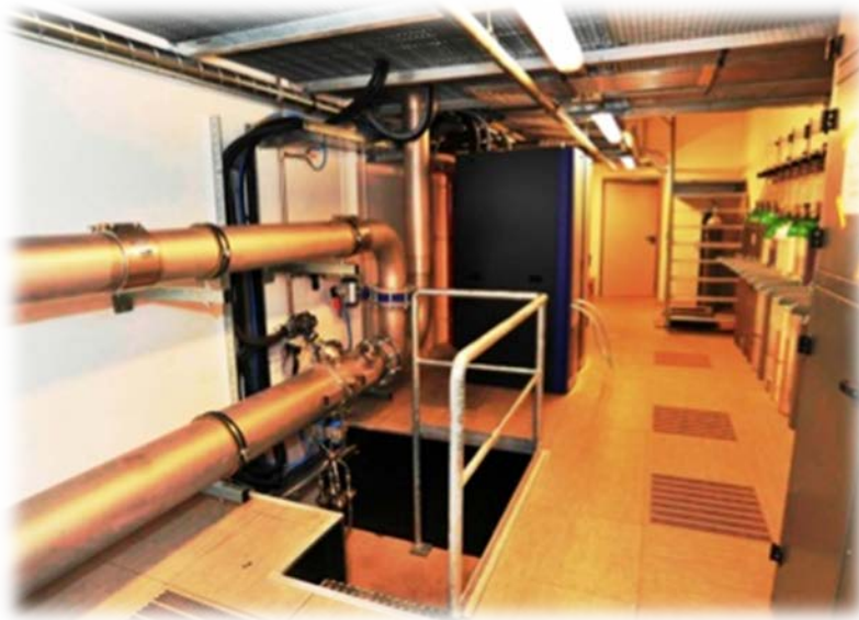
Abbildung 3.4: Otto- und Diesel-Verdünnungstunnel
