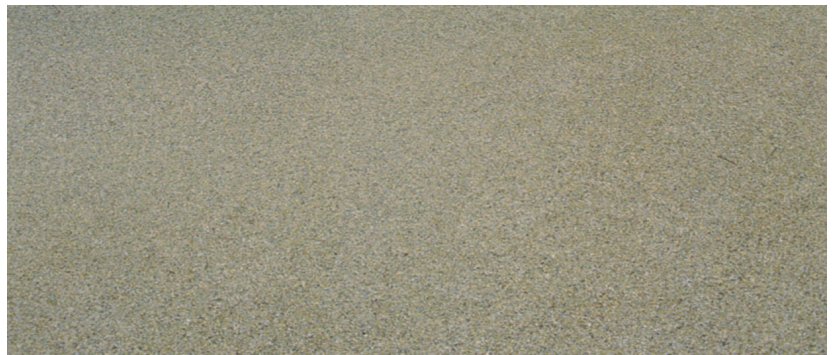
Bild links: Materialität Asphaltmastix; Quelle: Mader, Günter; Zimmermann, Elke, Bodenbeläge im Freiraum, München 2009 Rechts: „Kirchplatz“ im M 1 200
