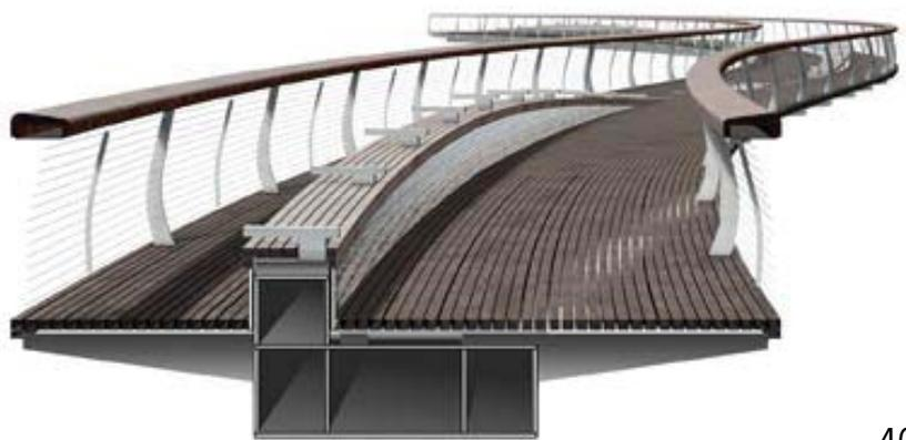
Das Hauttragwerk besteht aus zwei Hohlkastenprofilen aus Stahl, auf denen die Sekundärkonstruktion der Gehfläche angebracht ist. Die Konstruktion besteht durch ihre einfache, schlanke Konstruktion, die durch einen massiven Holzhandlauf abgeschlossen wird. Unterhalb des Handlaufes ist versteckt die Beleuch-
