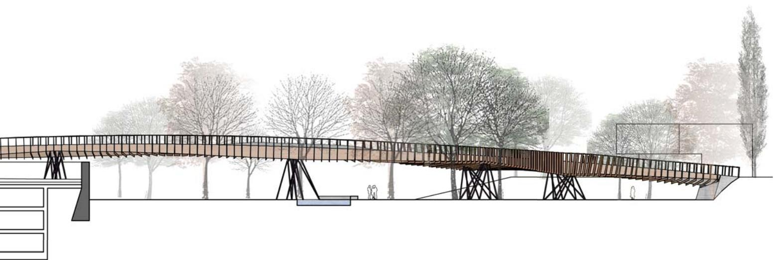
Die Konstruktionsweise des Tragwerks warf die Frage auf, wie einfach solche zweiseitig gekrümmten Träger hergestellt werden können. Es gibt einige Firmen in Österreich, die über das Know-how und die Technik verfügen solche Elemente herzustellen. Als Referenz kann das Centre - Pompidou in Metz oder das Vordach des Austria Centers in Wien gesehen werden. In beiden Projekten wurden zweiseitig gekrümmte
