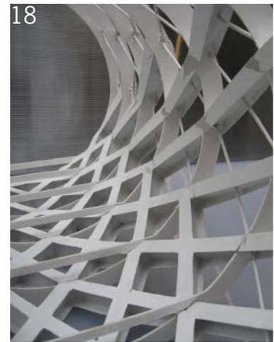
In der Darstellung der Kraftverteilung (siehe Abb. 17) wird ersichtlich, dass bei der mittleren Stütze die größten Stützmomente auftreten. Daraus resultieren zum einen die Verdichtung der Rahmen hin zum mittleren Auflager und auch die nötige Verstärkung und Aussteifung der Trag-
