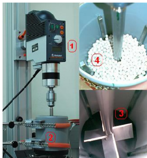
Abbildung 3-7: (1) Rührwerk, (2) Rührbehälter, (3) Innenansicht des Rührbehälters, (4) Befüllter Rührbehälter
