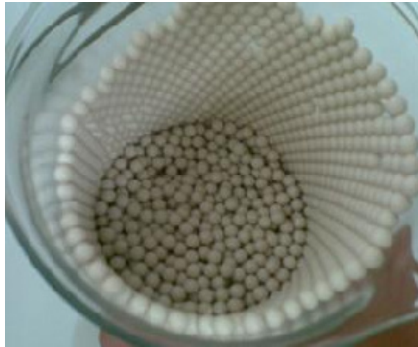
Abbildung 4-22: Darstellung des Effekts von elektrostatischen Kräften bei falscher Werkstoffwahl.
