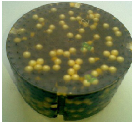
Abbildung 3-8: Harzeinguss einer Kugelmischung.
