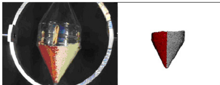
Abbildung 2-12: Realer Doppelkonusmischer (links) mit Simulation (rechts) [18]
