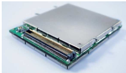
Abbildung 3.6: UC864-E Modem der Firma Telit
