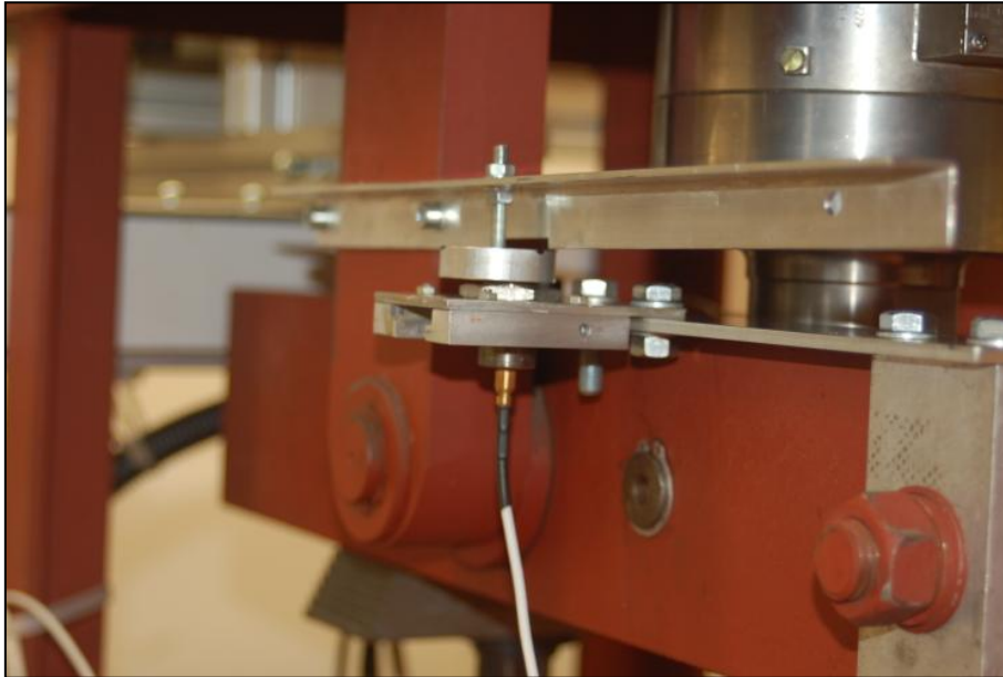
Abbildung 40: Berührungslose Wegmessung mittels Wirbelstromsensor
