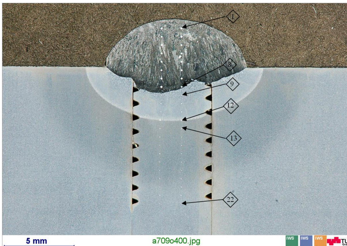
Abbildung 60: Härteeindrücke bei der Implant-Probe 3
