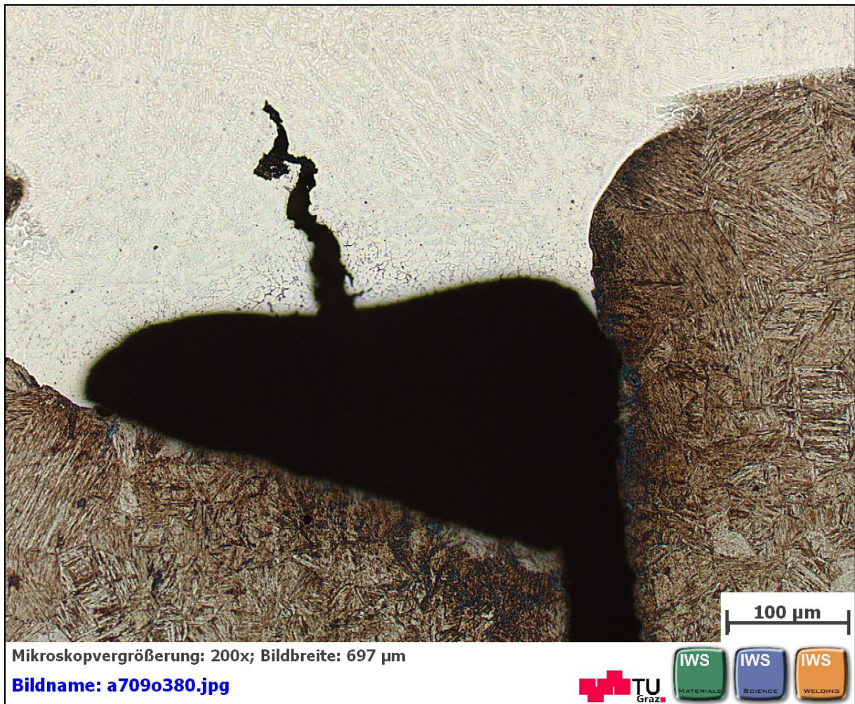
Abbildung 63: Aufnahme des Risses in der Implant-Probe 3 V2A-Beize
