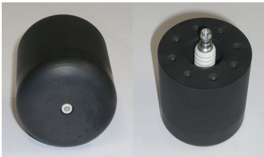
Abbildung 96: Elektrode mit Triggerelektrode
