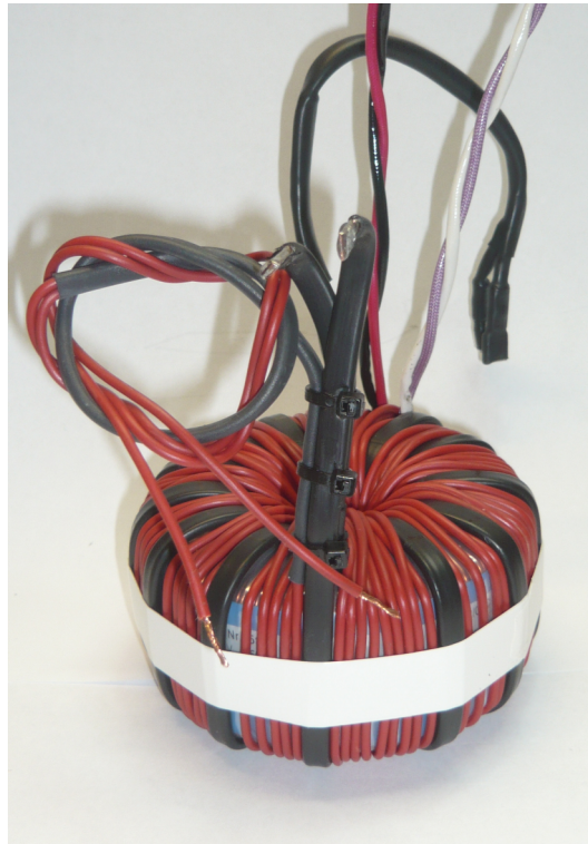
Abbildung 33: Standardtransformator mit zusätzlichen Wicklungen
