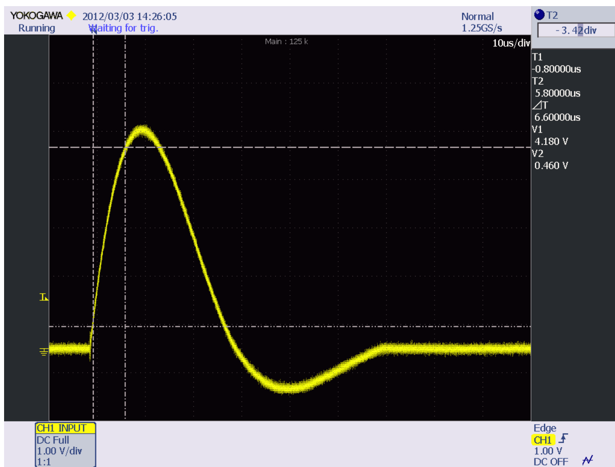
Abbildung 115: Kurzschluss - Anstiegszeit des Stoßstroms
