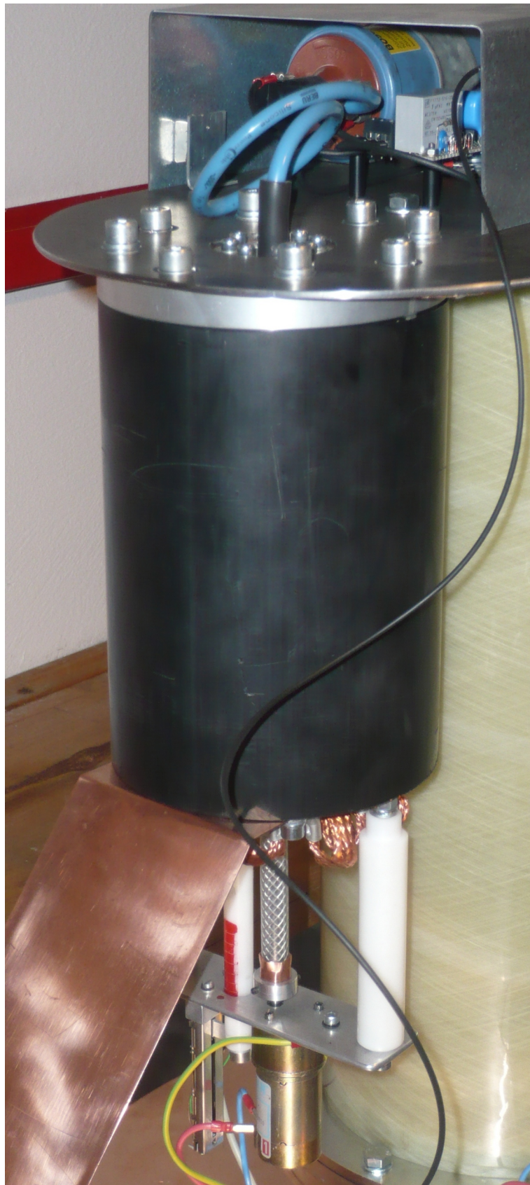
Abbildung 101: Schaltfunkenstrecke mit Antrieb und Zündeinrichtung
