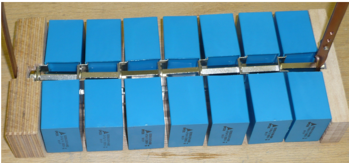
Abbildung 28: Fertig aufgebauter Stoßkondensator
