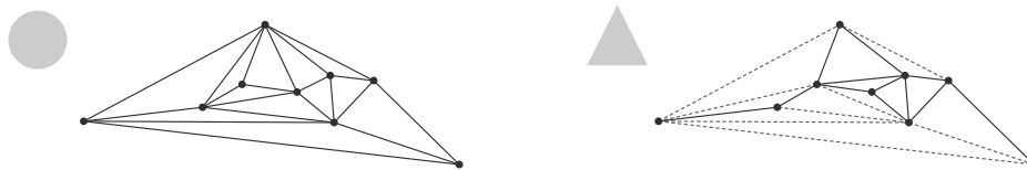
Abbildung 48: Beispiel einer gewöhnlichen DT(S) im Vergleich zu einer DT_C(S) mit dreieckigem Shape, wo die ungültigen (strichlierten) Kanten das eigentliche Gerüst der Delaunay-Kanten zu einer vollständigen Triangulierung auffüllen.
