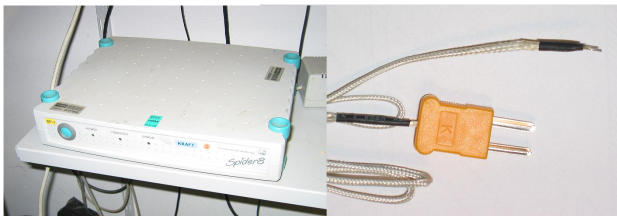
Abb. 16: links: Datenerfassungseinheit Spider 8 rechts: Thermoelement Typ K
