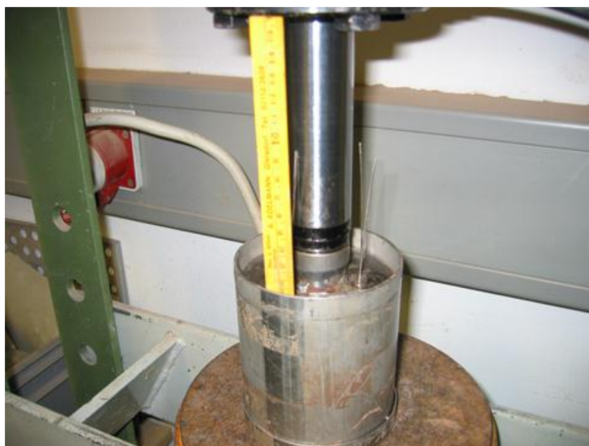
Abb. 19: Verdichten mittels hydraulischer Presse
